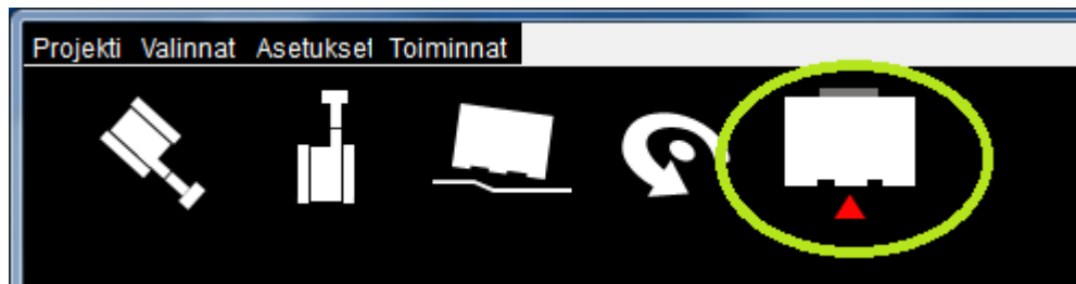
Kuva 11. Kauhan mittapisteen valinta Novatronin koneohjausjärjestelmässä. Kuva Novatronin LandNova -ohjelmistosta.
