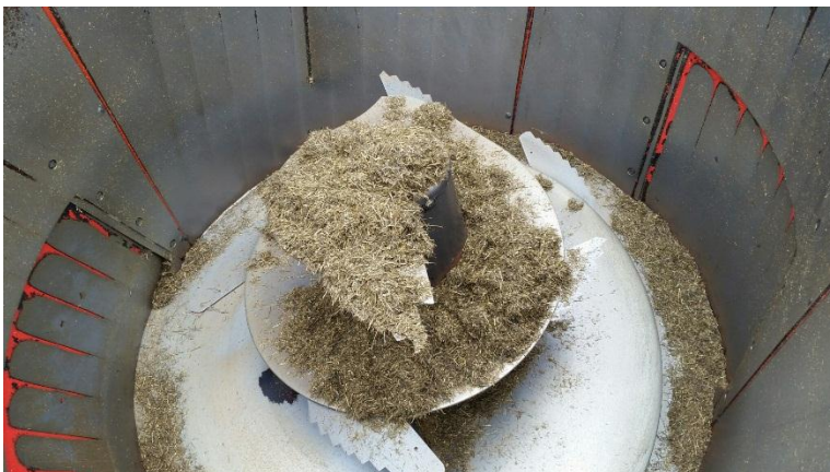
KUVIO 5. 1-ruuvinen pystyruuvivaunu (Kettunen 2015.)
