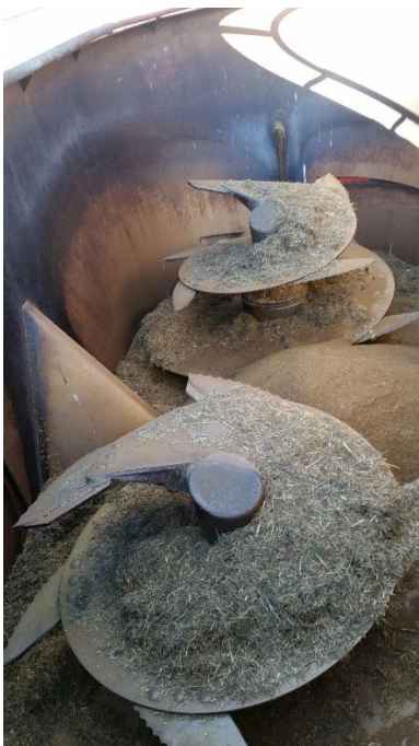
KUVIO 4. 2-ruuvinen pystyruuvivaunu (Kettunen 2015.)
