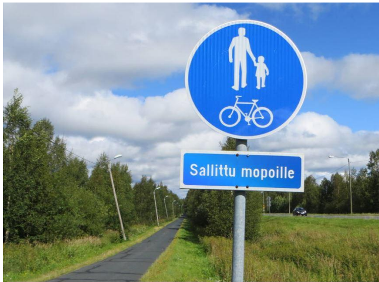
Kuva 4 Yhdistetty pyörätie ja jalkakäytävä ja lisäkilpi "sallittu mopoille"
