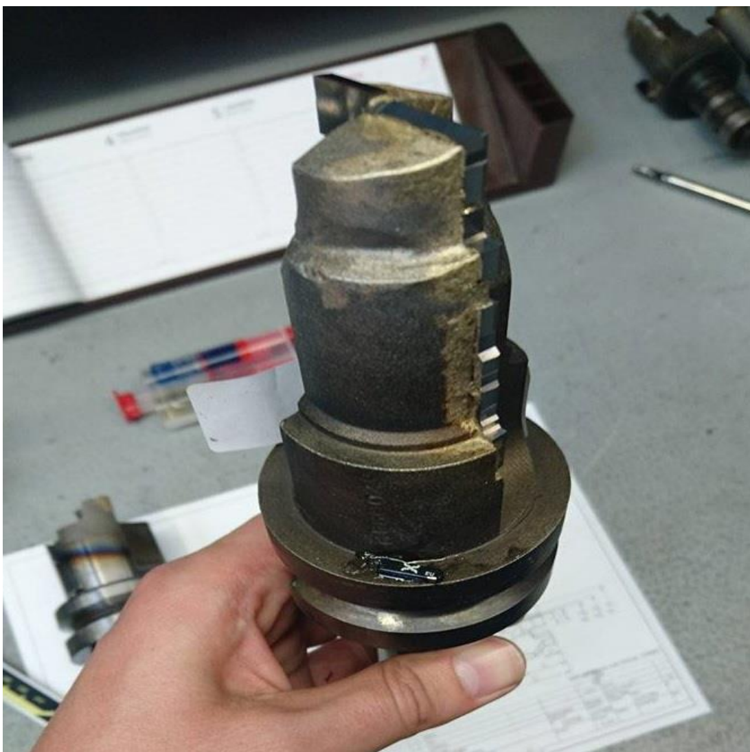
Kuva 4. RFID-tagin kiinnitettyä terään.
