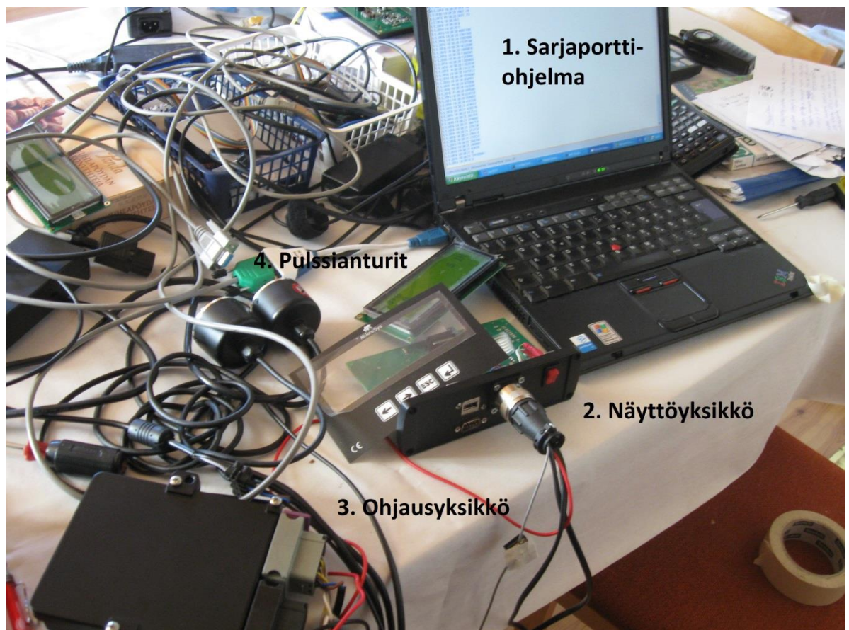
Kuva 2. Mittalaitteen kokoonpano testauksessa: 1. PC:n sarjaporttiohjelma, 2. näyttöyksikkö, 3. ohjausyksikkö ja 4. pulssianturit.
