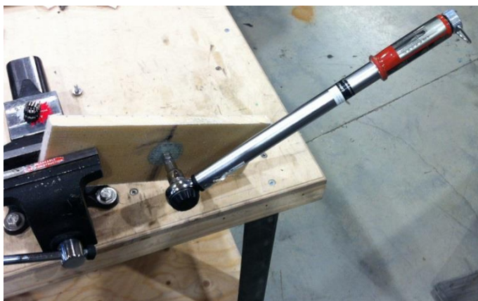
Kuva 39. Vääntökokeessa käytetty menetelmä
