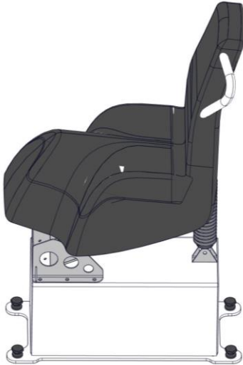
Kuva 21. Penkin kiinnitys neljästä pisteestä
