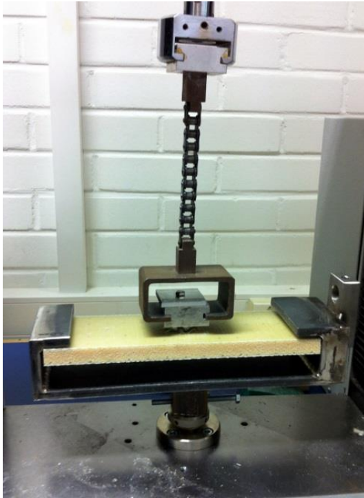
Kuva 37. Vetokokeessa käytetty menetelmä
