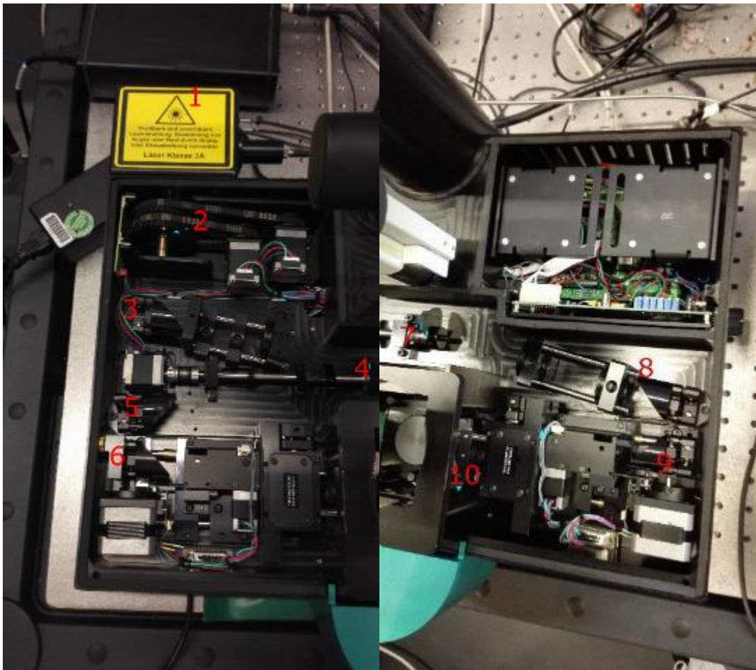
Kuva 8. LaVision Biotecin valotasomikroskooppi, jossa numeroituna tärkeimmät osat. Numero 1 on virtalähde, numero 2 on filterinvaihdin ja numerot 3–10 ovat peilejä, joilla laservalo saadaan ohjattua näytteeseen.
