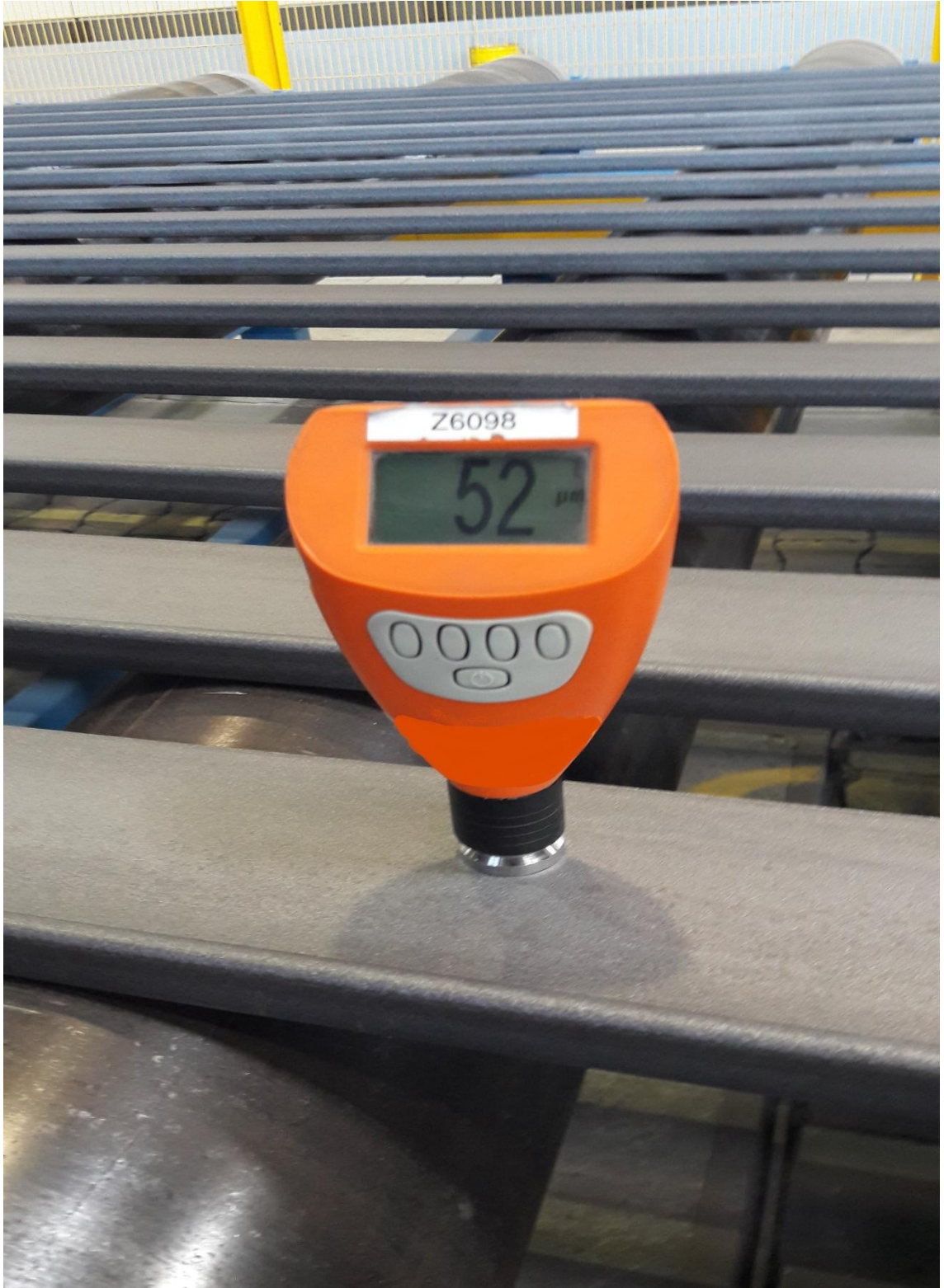
Kuva 12. Pinnankarheustesti ennen maalausta
