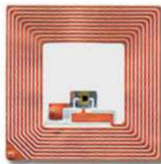
KUVIO 8. Tyypillinen passiivinen RFID-tunniste (Estelle Networks 2006.)
