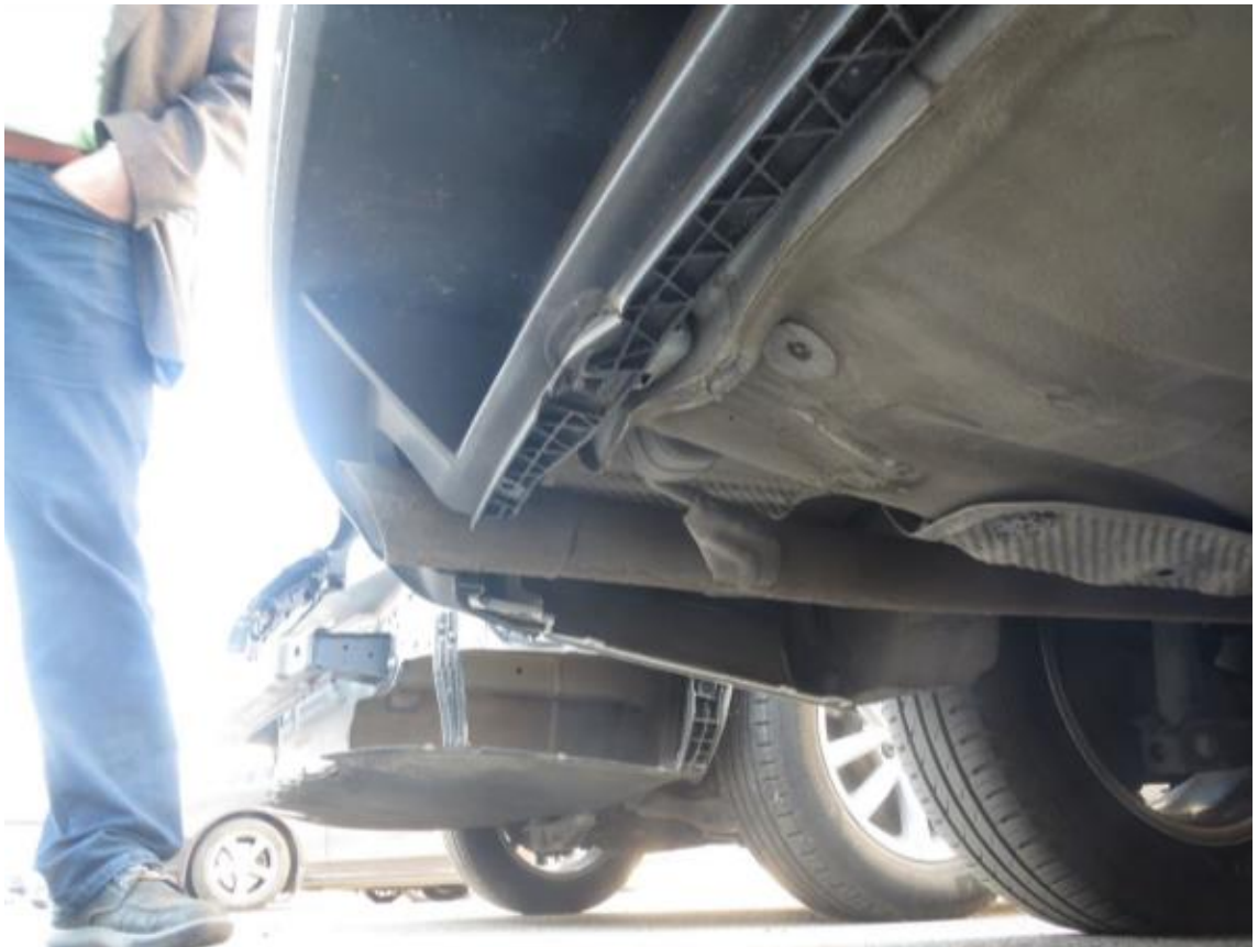
Kuva 7. Volkswagen Golf Variant, varapyöräkotelon vauriot ulkoa päin
