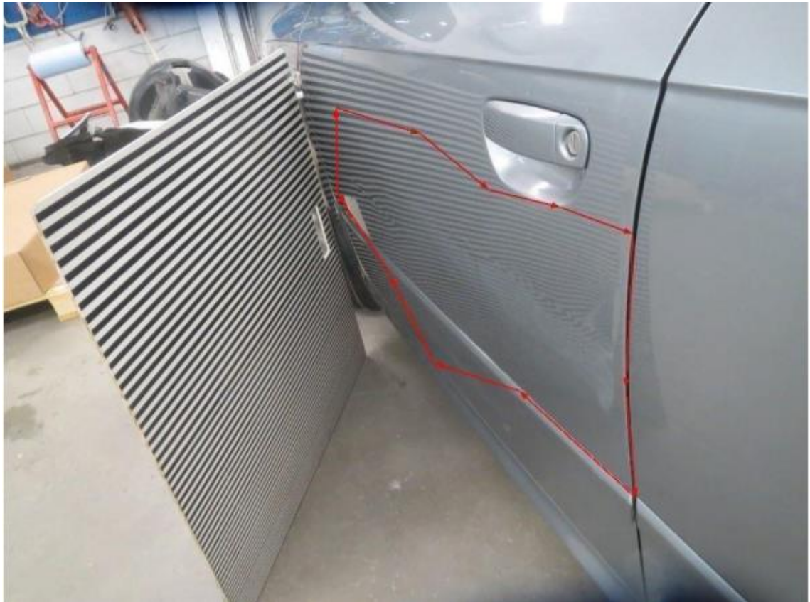
Kuva 5. Audi A4, vasen etuovi. Valokuva on otettu vaurioituneesta etuovesta viivataulua apuna käyttäen.
