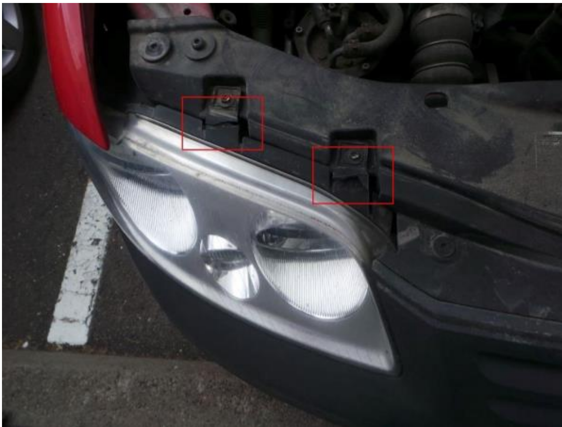
Kuva 6. Volkswagen Caddy, oikean etukulman vauriot. Alustavan laskelman vauriokuva.
