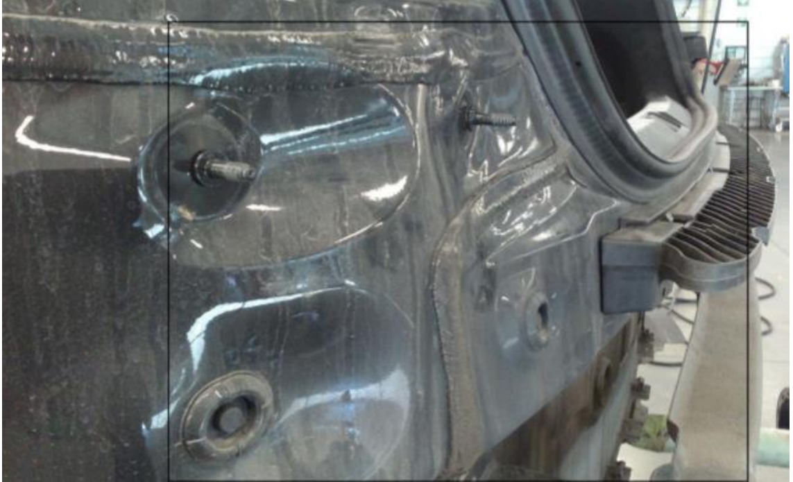
Kuva 12. Volkswagen Passat, vasemman takakulman vauriot. Vauriokuva takapuskurin alta.
