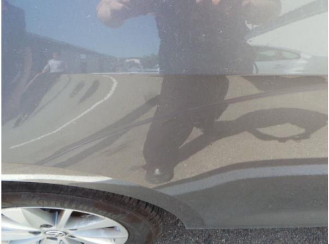
Kuva 9. Volkswagen Golf, painauma oikeassa kyljessä. Alustavan korjauskustannuslaskelman vauriokuva.
