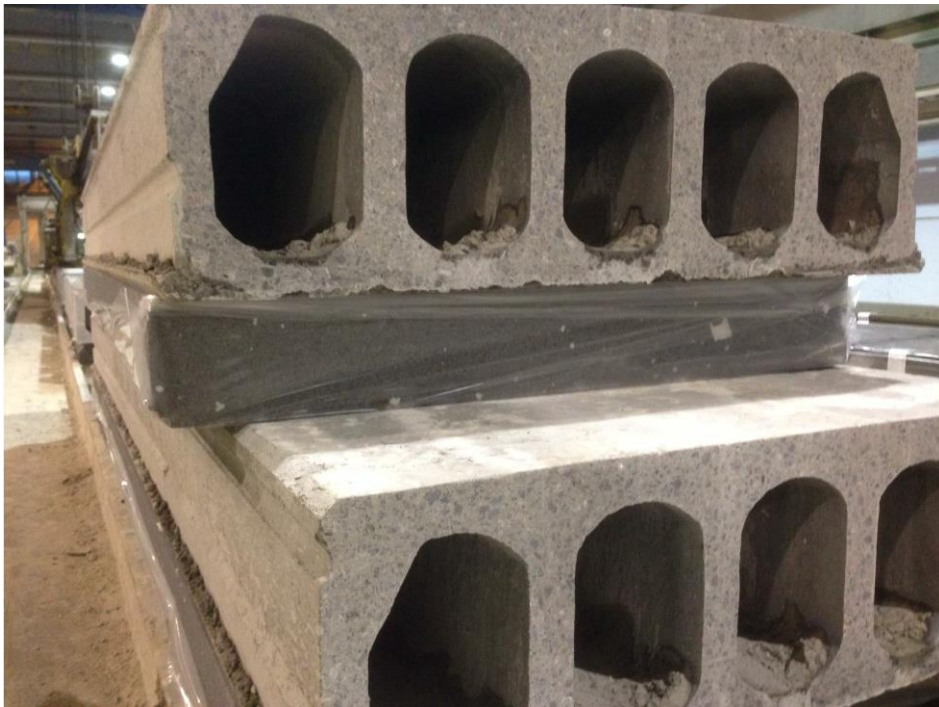
Kuva 7. Eriste ontelolaattojen välissä.
