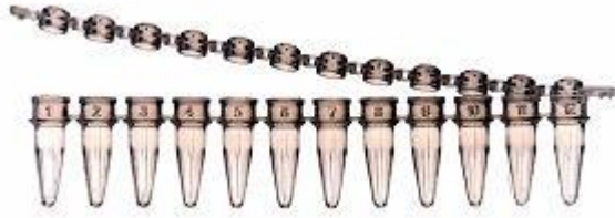
KUVIO 12. PCR ”strippejä” alhaalla ja ”striippien” kannet ylhäällä (Mukailen LightLabs 2008).
