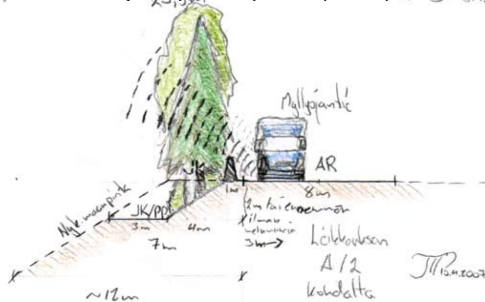
Kuva 130. Luonnos Myllyojantien kevyenliikenteen väylän parantamisesta
