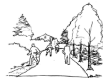
Kuva 10. Esimerkki hyväntasoisesta liikkumisväylästä. Päälystetyt osuuden leveys on 3,5 - 4 m, sorapiennar lenkkeilyyn 0,6 m. (Kevyen liikenteen väylät liikuntapaikkoina 2005, 35.)
