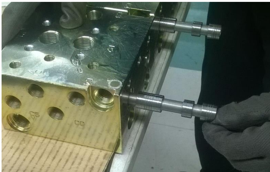
KUVA 2. Karan asennus. (Valokuva Tapio Jauhiainen 2016).
