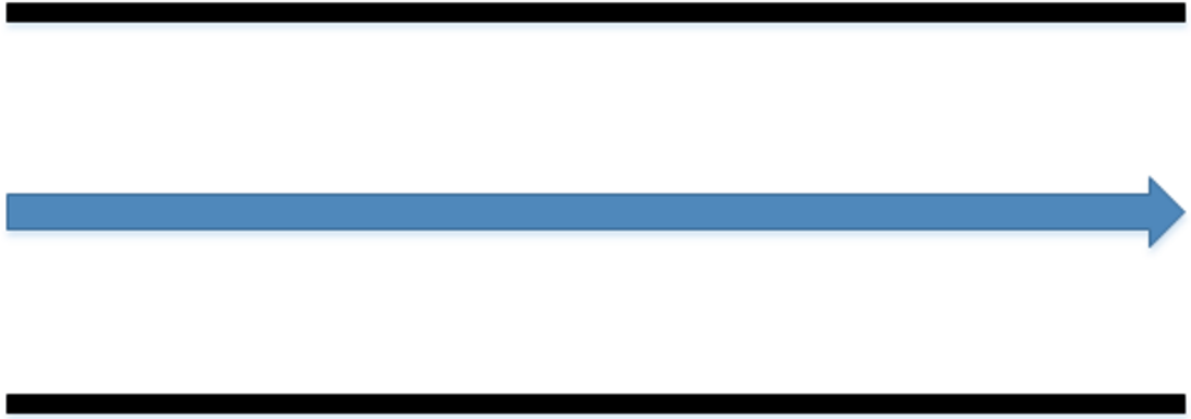
Kuvio 6. Yksimuotokuidun valo etenee suoraan
