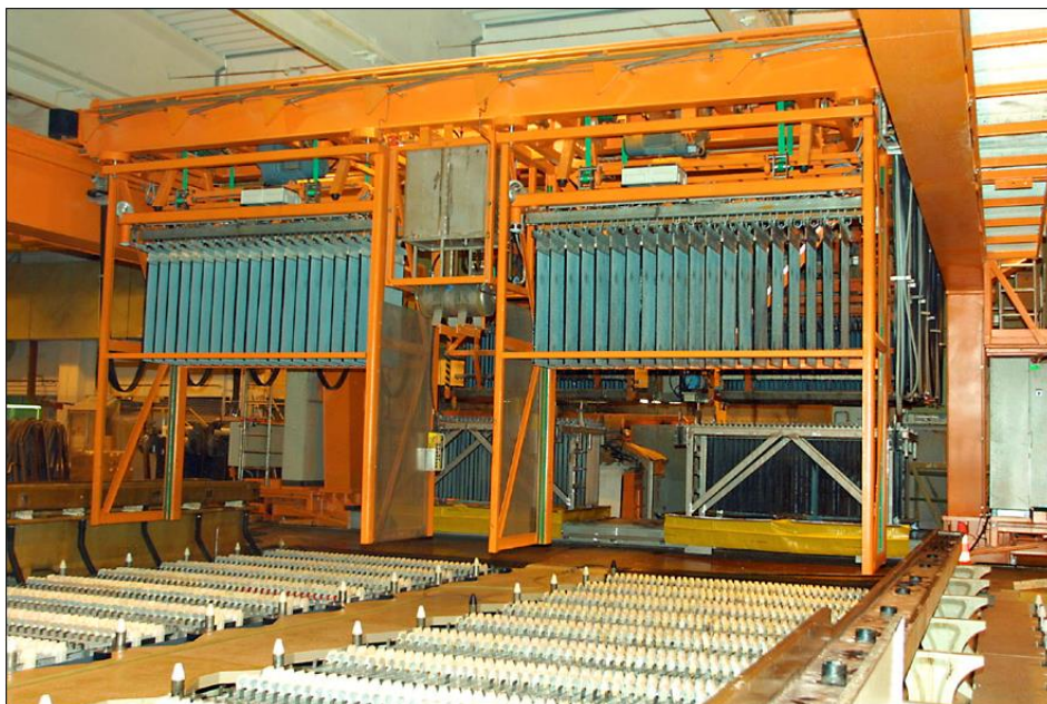
Kuva 12. Katodit nostovaunussa altaiden päällä (Boliden Kokkola 2008a.)
