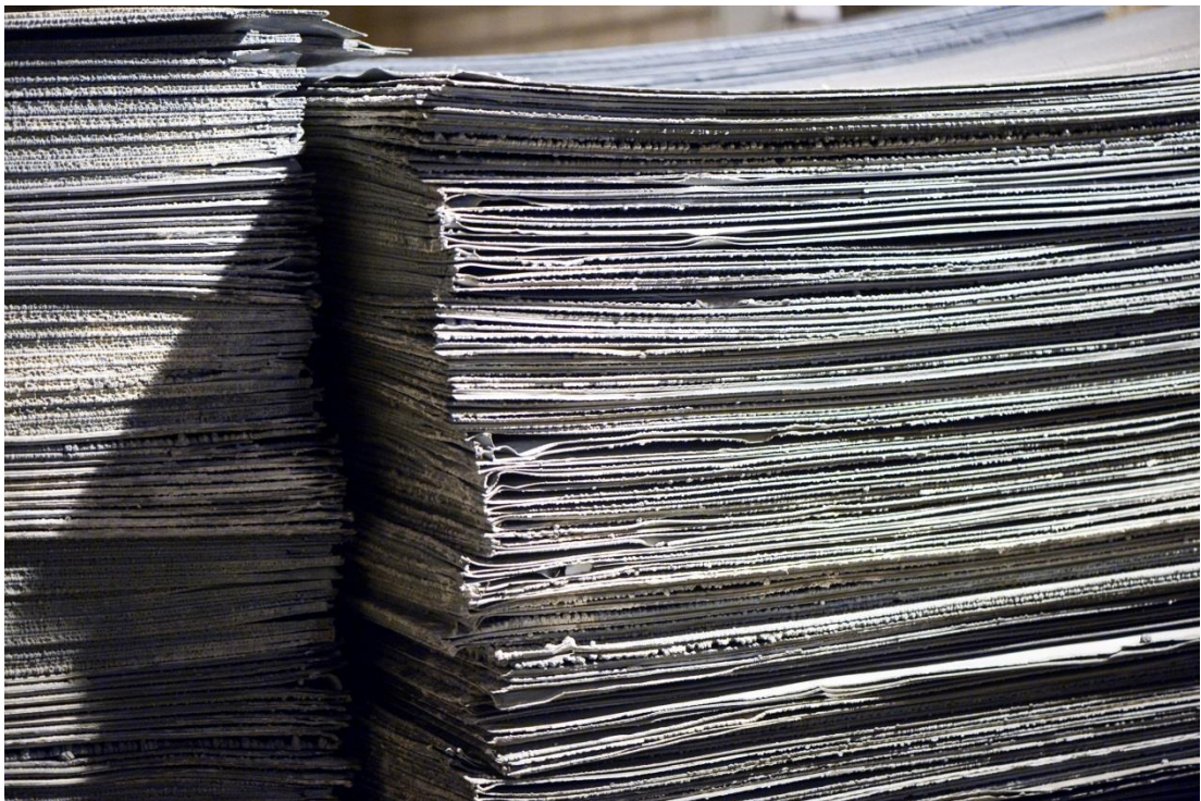
Kuva 7. Katodisinkkiä (Boliden 2016b.)
