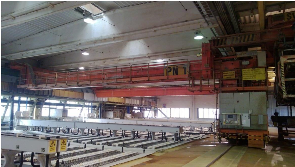
Kuva 11. Puolipukkinosturi (Boliden Kokkola 2008a.)
