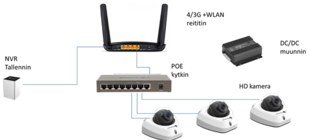
Kuvio 7. Ajoneuvon kalustus. DC/DC jännitteen nostin 24/48 V.
