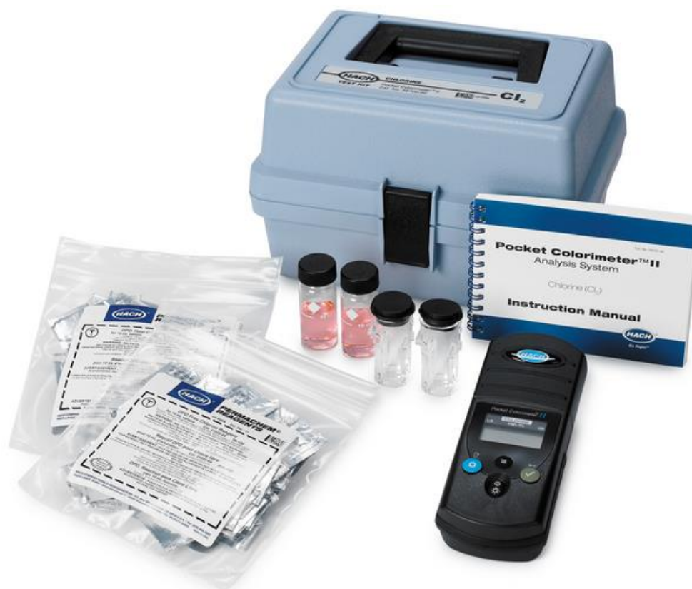
Kuva 6. Hach poket colorimeter 2. Mittaus tapahtuu fotometrisesti, perustuen (N,N-dimetyyli-p-fenyylidiamiini) DPD-kolorimetriseseen metodiin. DPD reagoi kloorin kanssa muodostaen punaista väriä, laite mittaa näytteen absorptiota aallopituudella 530 nm. Laitteella voidaan mitata vapaan kloorin pitoisuutta sekä kokonaiskloorin pitoisuutta. [12;18.]
