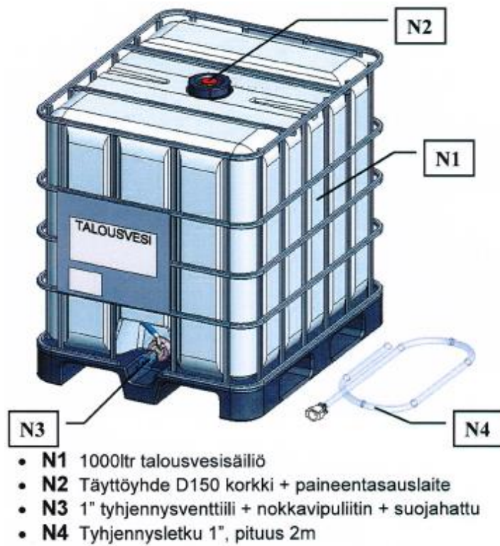
Kuva 5. Vesisäiliö 1000 l, rakennekuva. [17.]
