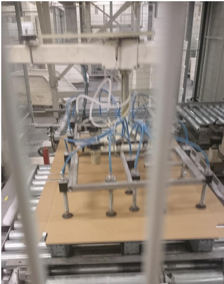
Kuva 7 Lavapahvinasetin asettamassa lavapahveja lavojen päälle.
