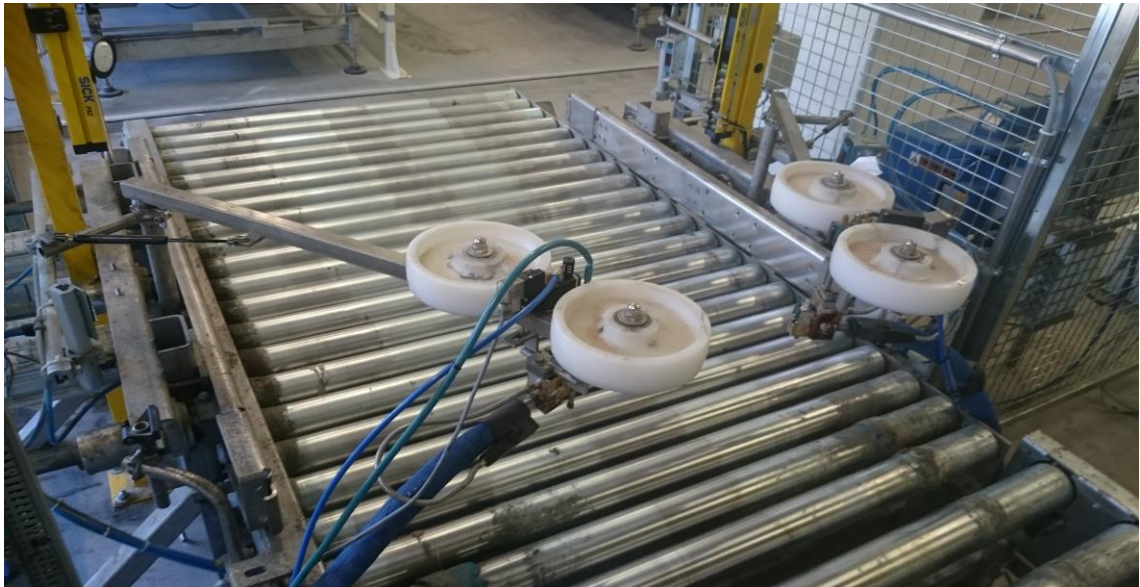
Kuva 11 Lavapahvien liimauslaite, teräspalkkien päässä liimapistoolit, ja taustalla näkyy sininen liimalaite.
