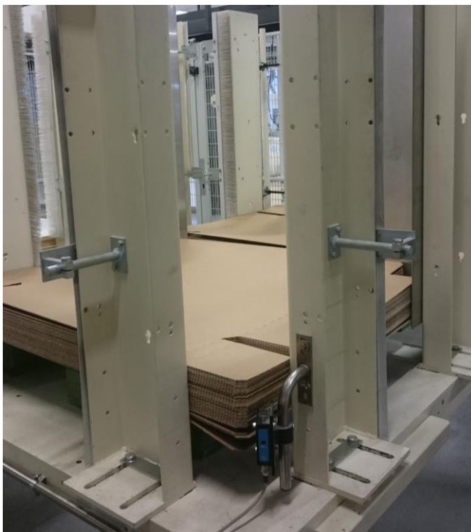
Kuva 17 Nykyinen lavapahvi makasiini. Säästöalue nähtävissä tolppien pohjassa.
