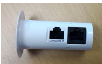
Kuva 34. Redwood ILNS-valaistusjärjestelmän tunnistin.
