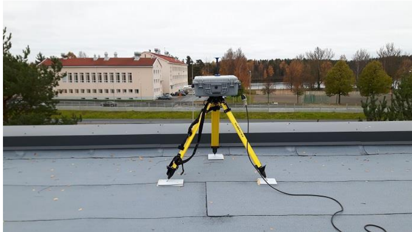
KUVA 6. TSI DustTrak™ DRX 8533 hiukkaspitoisuuden mittari Mikkelin ammattikorkeakoulun katon mittauspisteessä (Kainulainen 2016)
