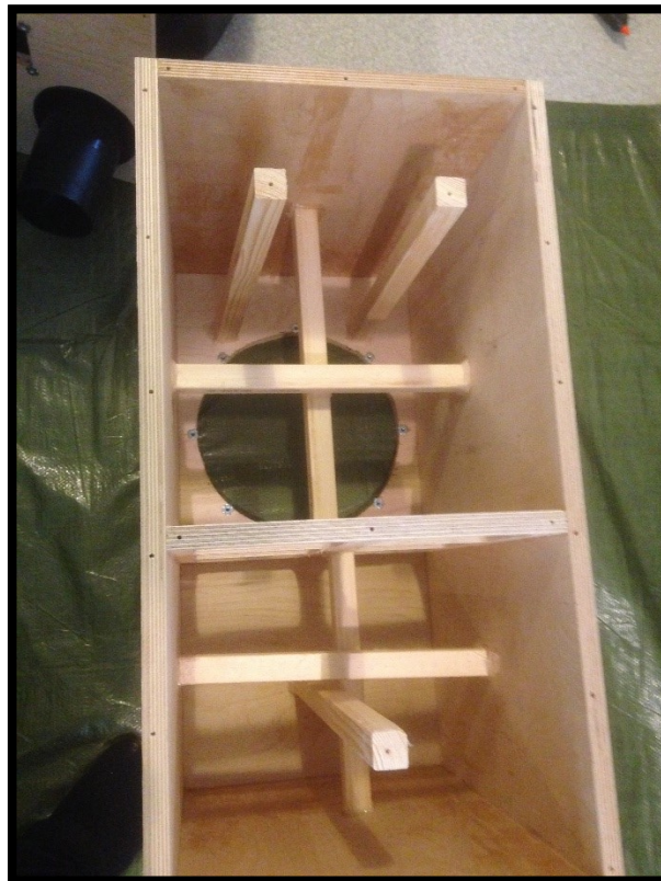
Kuva 16 Kotelo on riittävän jäykkä
