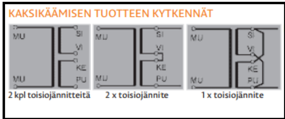
Kuva 28 Trafox rengassydänmuuntajan kytkentätavat (Trafox Oy 2016).
