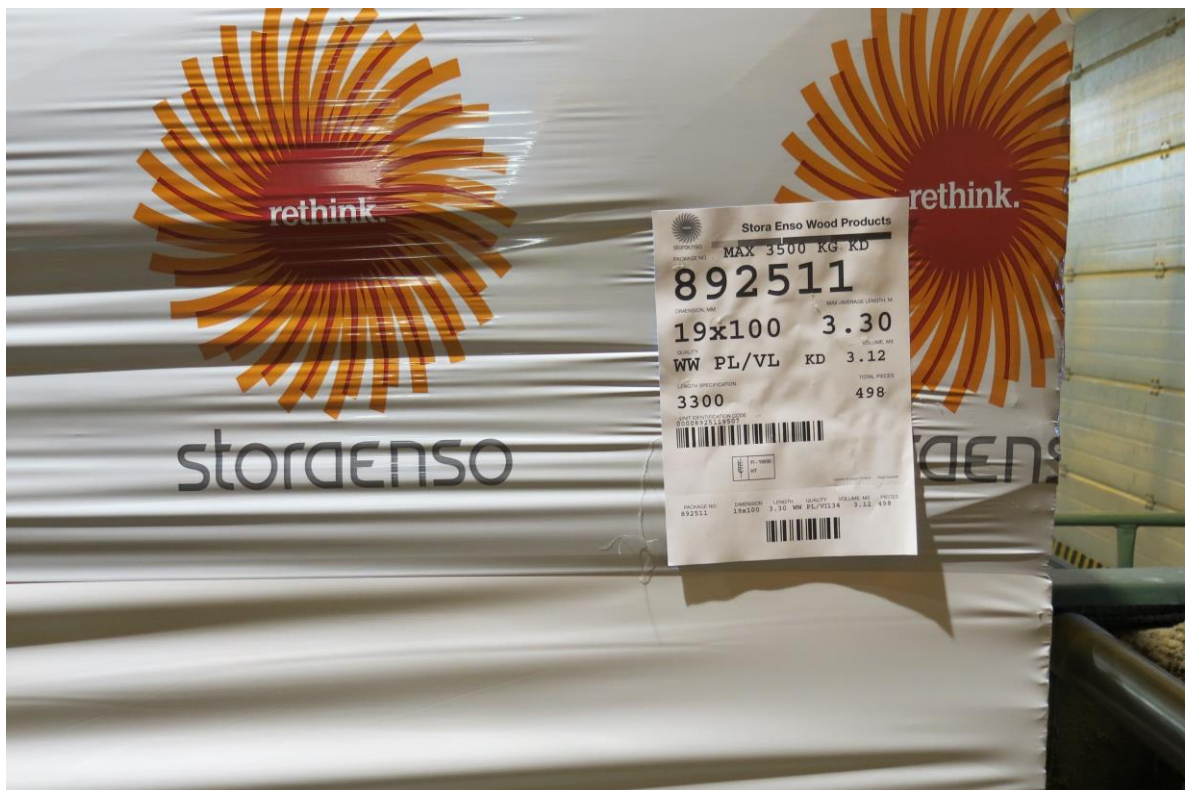
Kuva 7. Valmis puutavara niputetaan ja kääritään suojamuoviin. Kuva: Juho Räsänen 2016.
