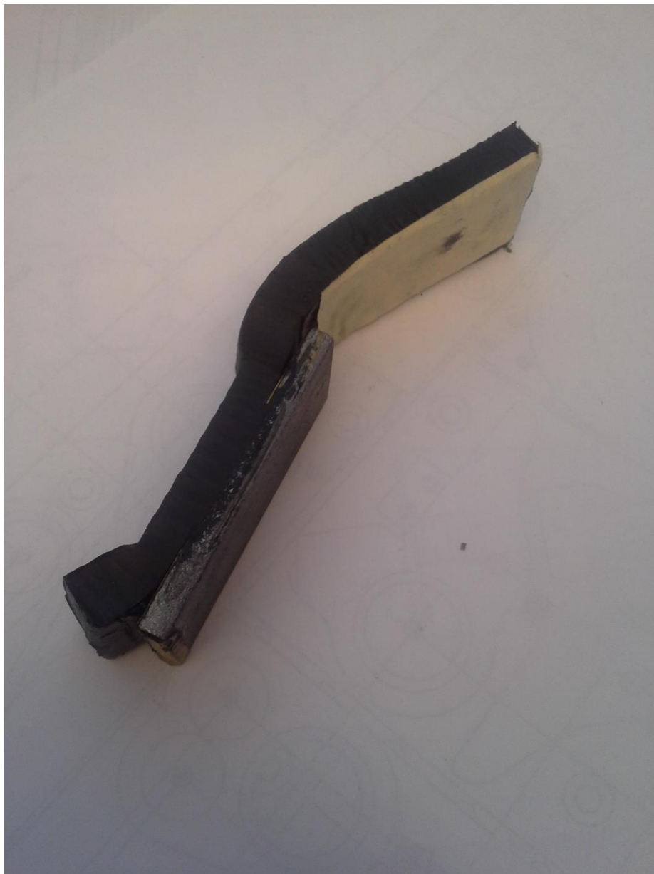
KUVA 9 Valmis testikappale, jossa kumi on liimattu metallilattaan (Perttu Hämäläinen, 2016.)
