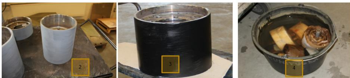
KUVA 3 Vanneputken hiekkapuhallus ja maalaus (Jyri Linnakoski, 2016.)
