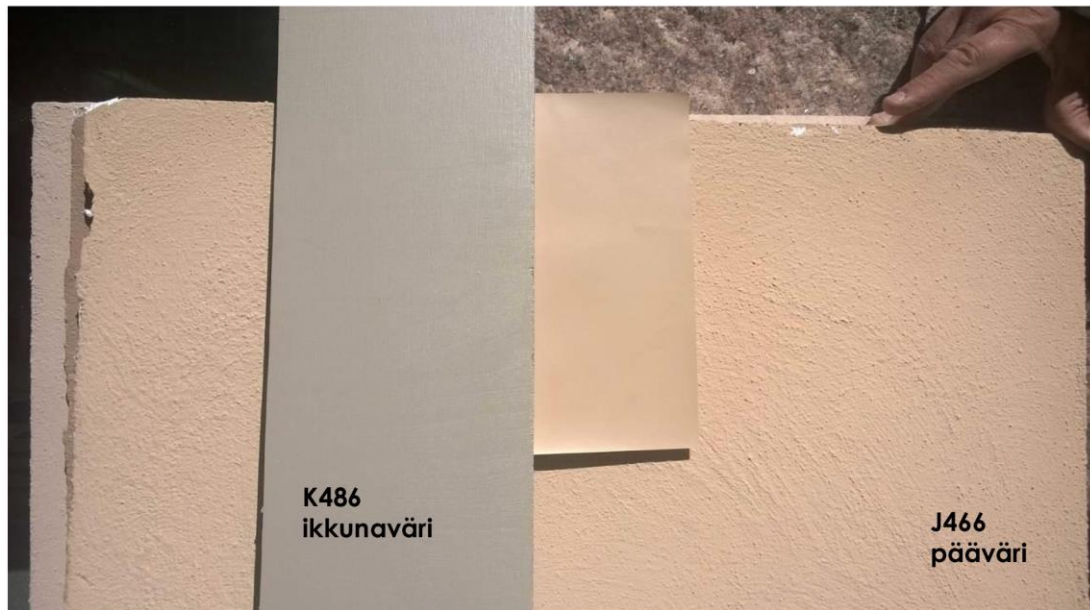
Kuva 7: Väriliuskavertailu: Värimallit on tehty silikaattimaalilla. Julkisivujen päävärin värimalli on hieman kirkkaampi kuin väriliuskassa → pyritään lähemmäs väriliuskan suuntaan lopullisessa kalkkisementtimaalauksessa. Edessä ikkunavärimalli, joka sopii hyvin sekä päävärin että harkkokerrosvärin kanssa. Todettiin, että pääväri on aika kirkas, mutta se tulee joka tapauksessa melko pian likaantumaan ja sammumaan ajan kuluessa.
