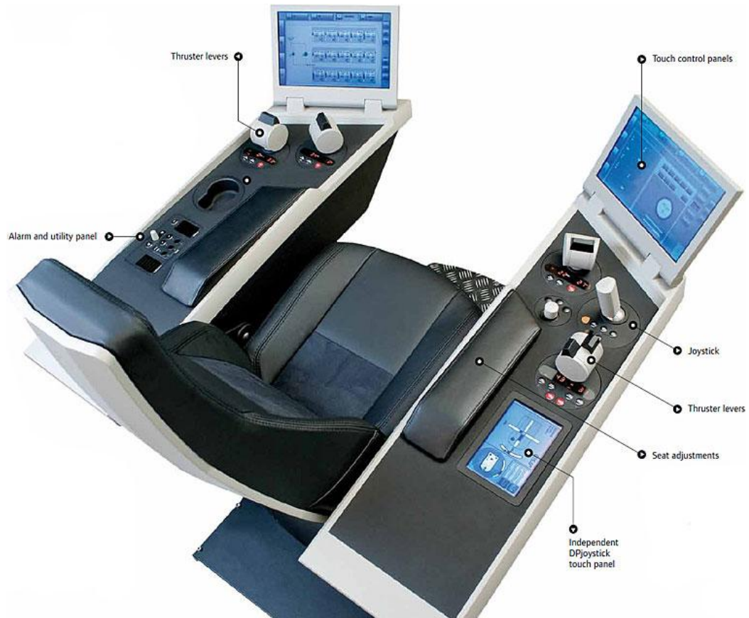
Kuva 6. Kongsberg K-Master integroitu työasema offshore-aluksille. ( http://www.km.kongsberg.com/ks/web/nokbg0239.nsf/obj/k-master-761x625.jpg/$File/k-master-761x625.jpg?OpenElement )
