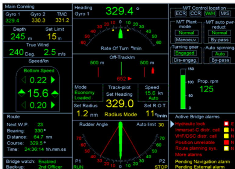
Kuva 5. Furunon komentosillan informaatiojärjestelmän Main Conning –sivu, josta selviää eri laitteiden tuottamaa informaatiota. (Lähde: http://www.furuno.fi/eng/products/bridge_information_system/ )
