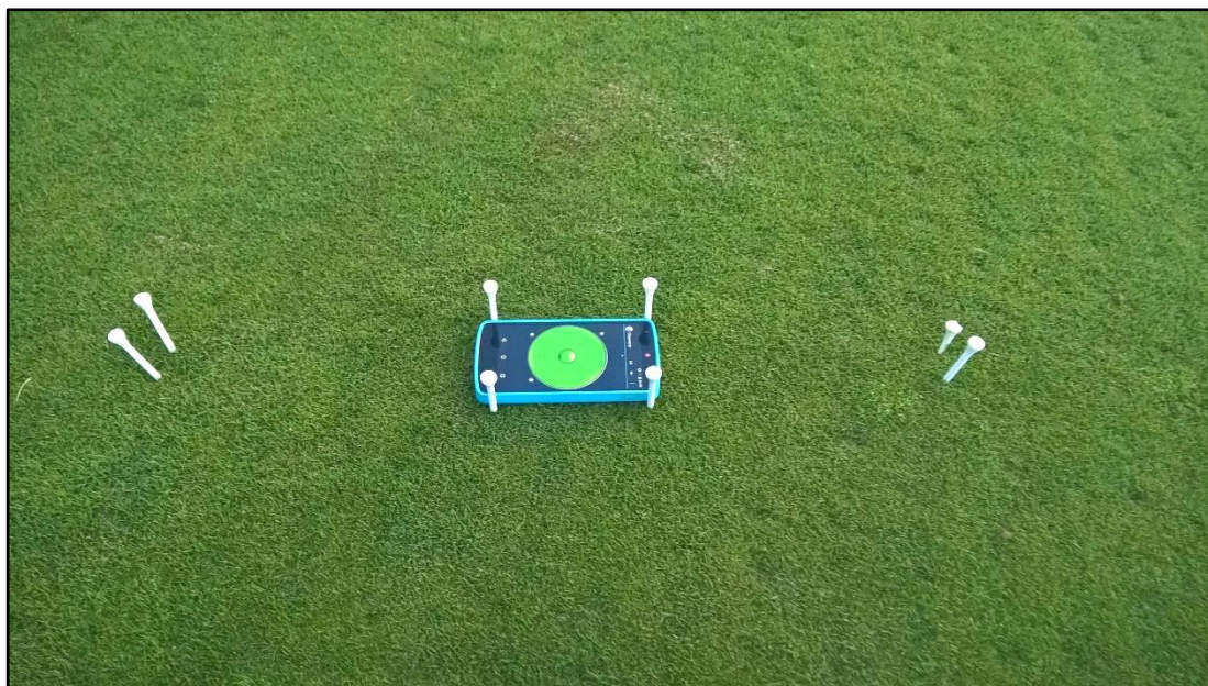
Kuva 4 LG:n älypuhelin toistettavuuskokeessa.
