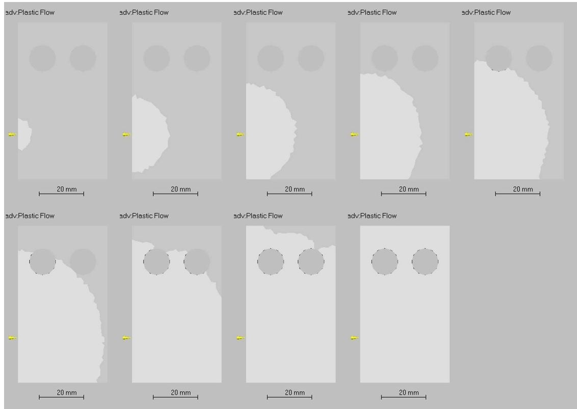
Kuvio 11. Plastic Advisorilla tehty simulaatio testimuotin pesän 2 täyttymisestä polystyreenillä.
