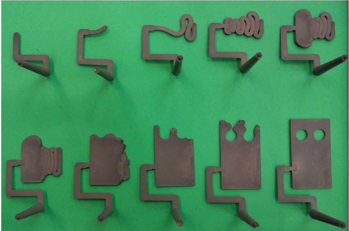
Kuvio 18. Neitseellisestä PolyMIM 8620-materiaalista ruiskuvalettu täyttymissarja 6 (testimuotin pesä 2).
