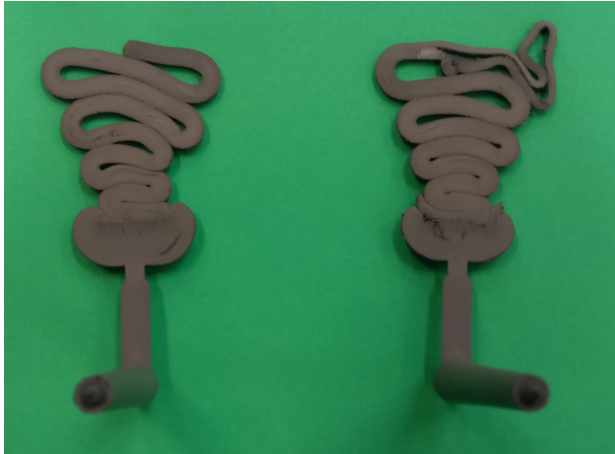
Kuvio 19. PolyMIM 8620-materiaalista hidastetulla ruiskutusnopeudella ruiskuvalettu koevalu 7 (testimuotin pesä 1).
