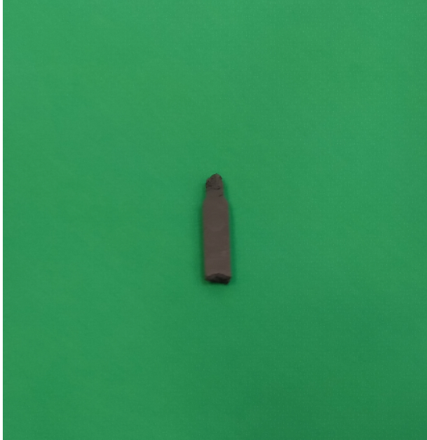
Kuvio 21. PolyMIM 8620-materiaalista mahdollisimman hitaalla ruiskutusnopeudella ruiskuvalettu koevalu 9 (testimuotin pesä 1).
