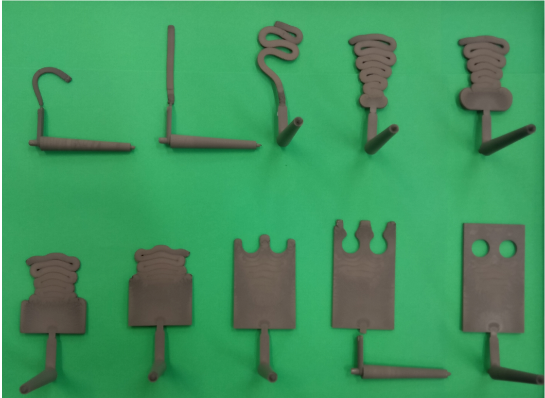
Kuvio 17. Neitseellisestä PolyMIM 8620-materiaalista ruiskuvalettu täyttymissarja 5 testimuotin pesään 1.
