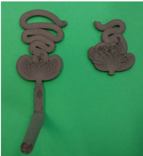
Kuvio 20. PolyMIM 8620-materiaalista profiloidulla ruiskutusnopeudella ruiskuvalettu koevalu 8 (testimuotin pesä 1).
