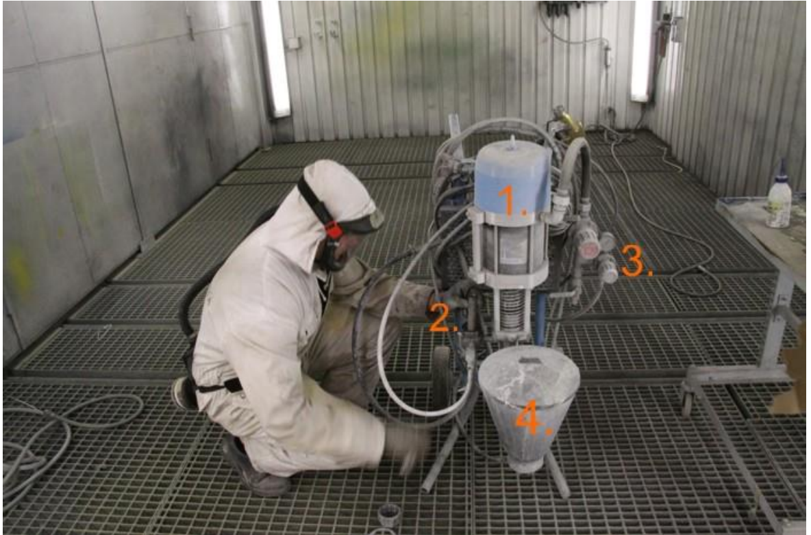
Kuvio 18. Korkeapainepumppu ja sen osat (Välkkynen 2013).
