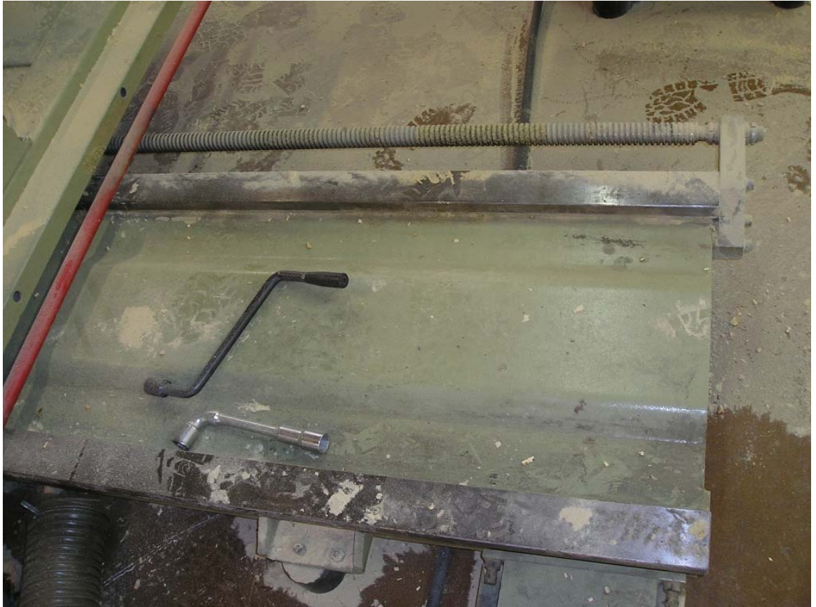
Kuva 14. Työkaluja ja puupölyä leveydensäätöpalkin ja kierteen päällä.
