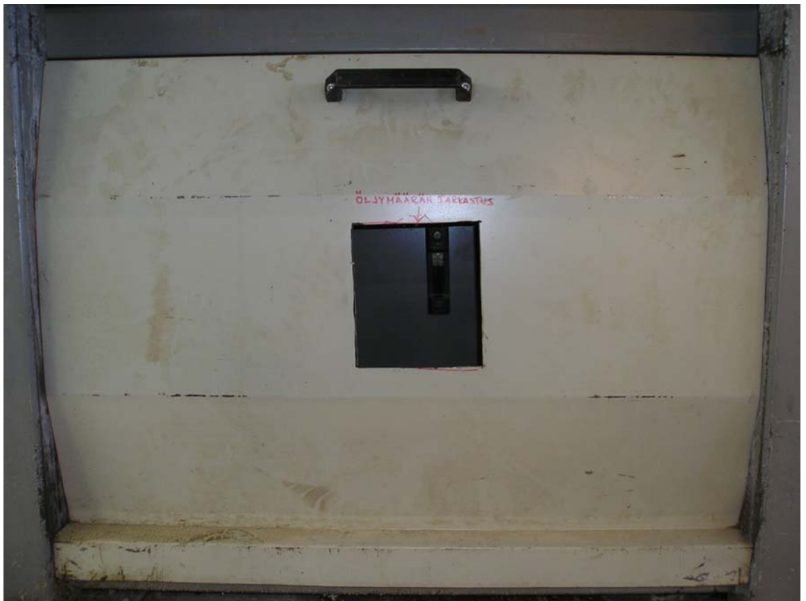
Kuva 12. Hydraulikkaöljyn määrän tarkastusta nopeuttava aukko kitkan suoja Pellissä.
