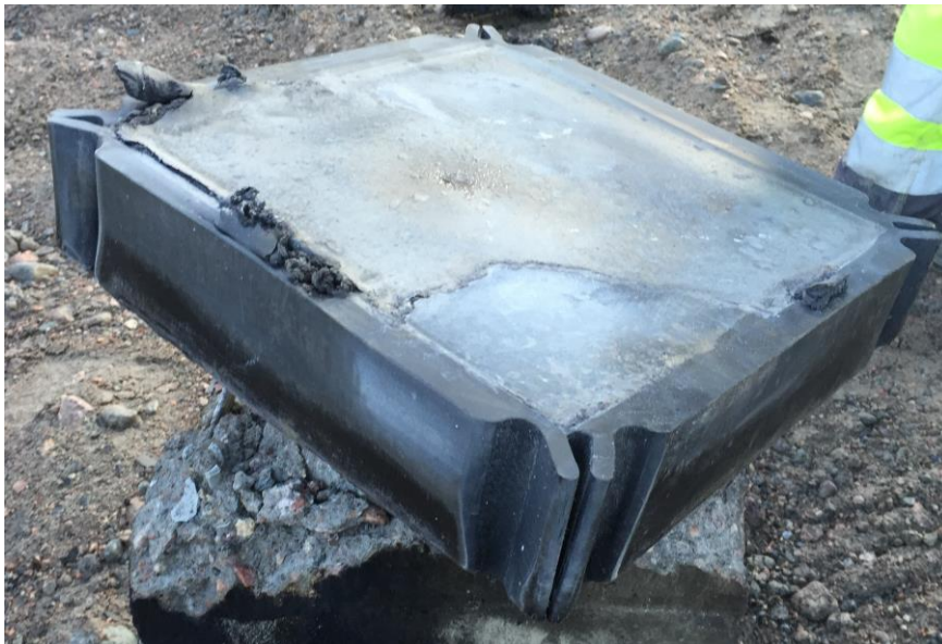
Kuva 14. Nylatron-iskutyyny ensimmäisen maahan lyödyn paalun jälkeen.
