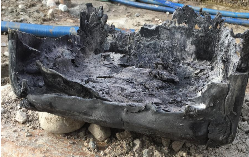
Kuva 15. Loppuun käytetty Nylatron-iskutyyny
