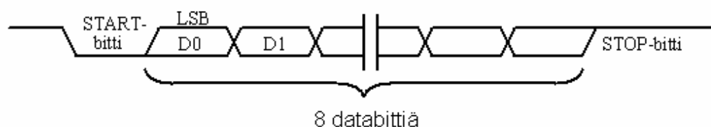
Kuva 6. Sarjamuotoisen tiedon bittikehys toimintamuodossa 1 [2]
