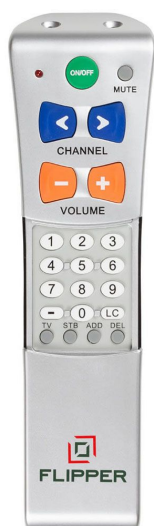
KUVA 5 . Kaukosäädin, jossa lisätoiminnot ovat luukun alla. (Alzproducts, 2017)
