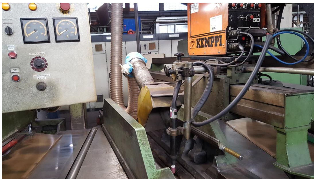
Kuva 3. Kemppi:n TIG-hitsauslaitteisto juurituella hitsaus- ja reunauskoneella valssaamoraennuksessa
