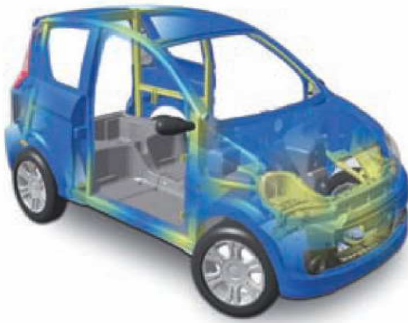
Kuva 3. Rungon ja korin yhteensovitus.
