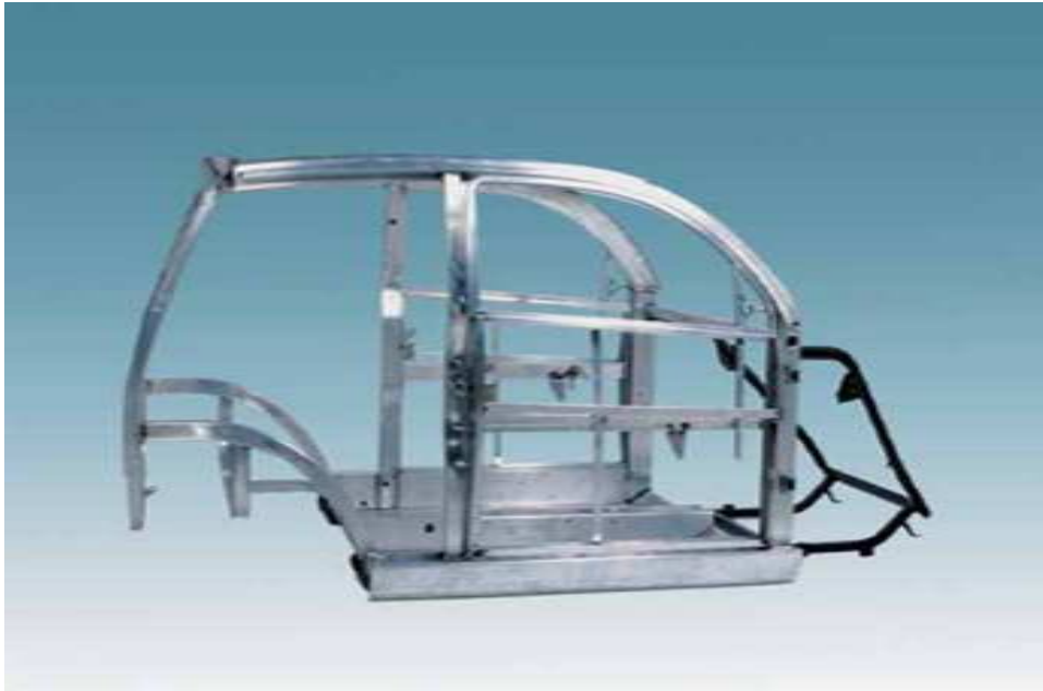
Kuva 2. Kirkkaampi osa alumiinia ja musta terästä.
