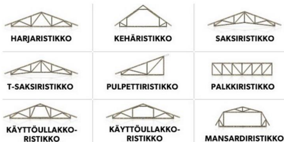
Kuva 15. Esimerkkejä yläpohjan kantavista rakenteista. (Rakentaja.fi www-sivut 2017)
