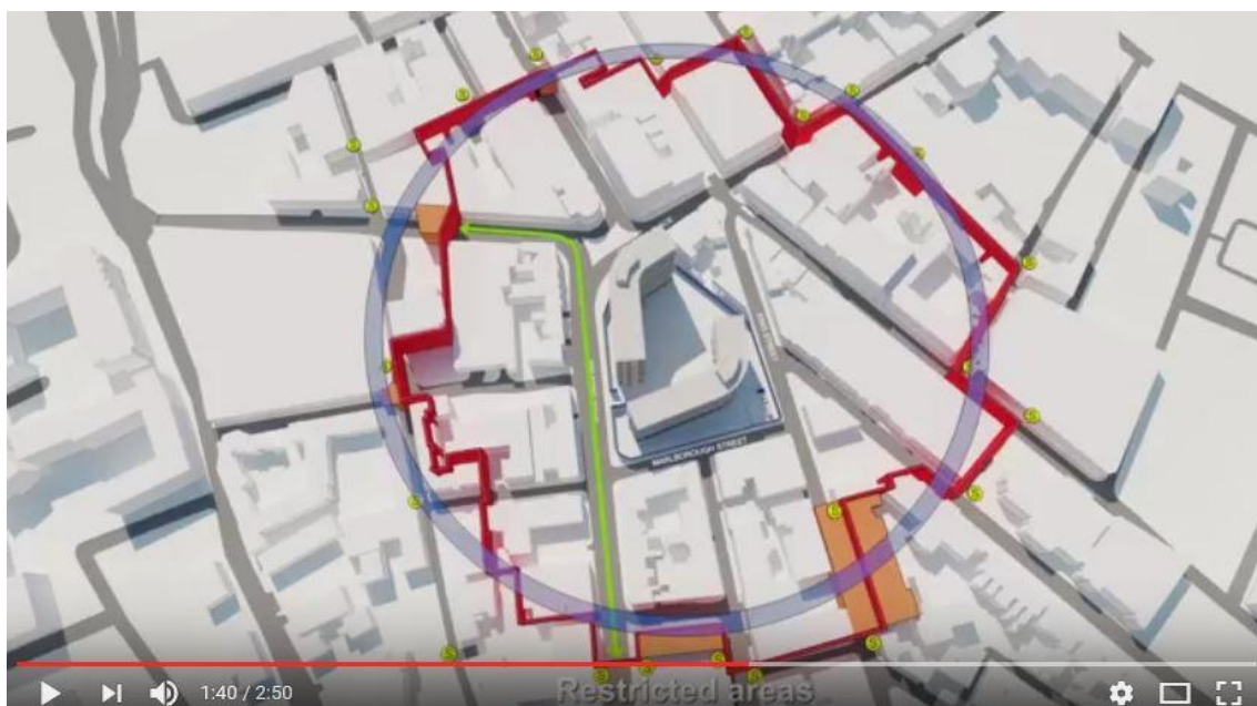
Kuva 59. Ote animaatiosta, jossa esitetty suojavyöhyke purkutyön aikana. (DSM Demolition Ltd, 2017.)
