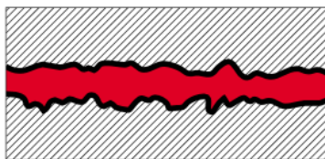
a) Täysvoitelu Kantava öljykalvo erottaa pinnat täydellisesti toisistaan.
