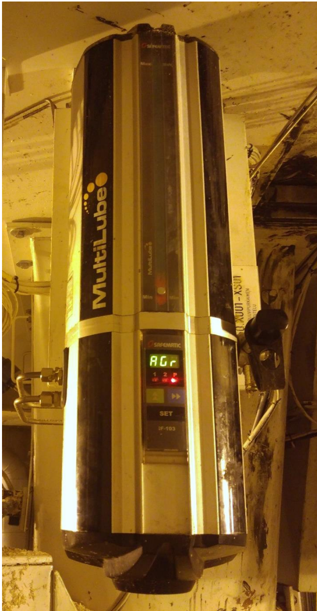
Kuva 15. SKF Multilube-keskusvoitelujärjestelmä (kuva: Henriikki Helander)
