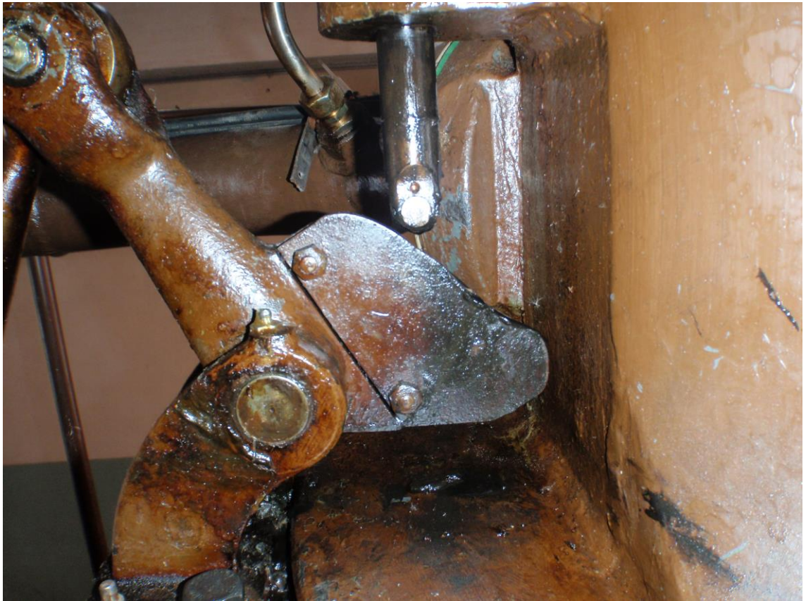
KUVA 18. Kombinaattorin säätötanko on kuluttanut kaarilaitteen profiilin pilalle.
