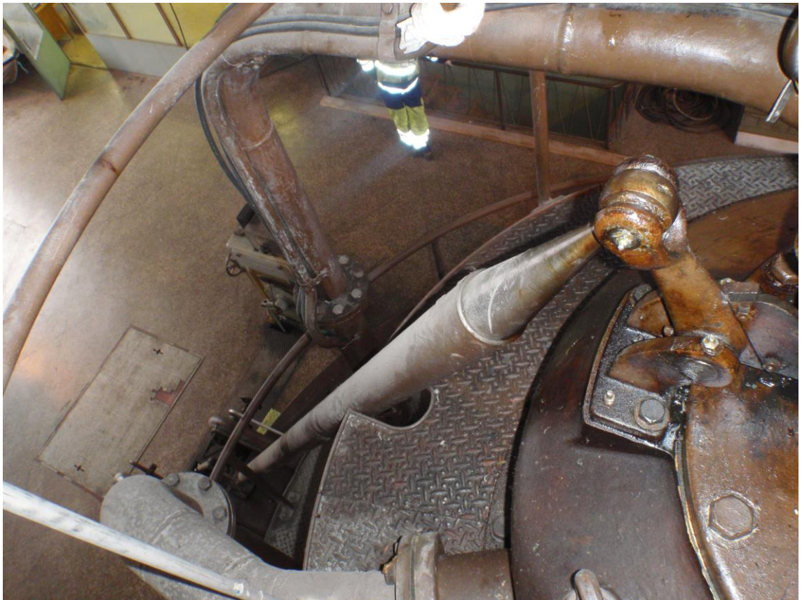
KUVA 19. Kaarilaite on kiinni säätötangossa, joka kiinnittyy suoja Pellin alla olevaan akseliin, joka saa voimansa säätäjältä.
