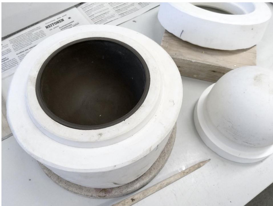
Kuva 8. Valmis kipsimuotti ensimmäisen punasavivalun jälkeen.
