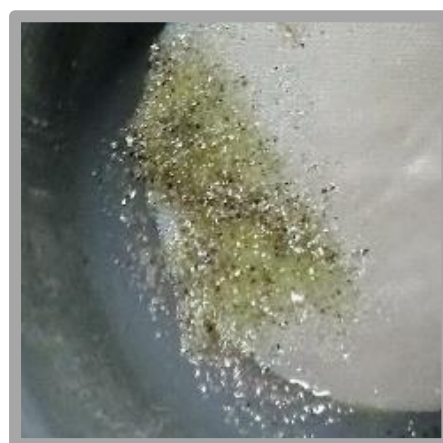
Kuva 10. Lasitteet seulottiin ennen lasittamista, jolloin seulaan jäi hieman karkeampaa lasijauhetta.
