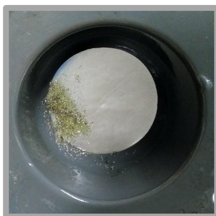
Kuva 10. Lasitteet seulottiin ennen lasittamista, jolloin seulaan jäi hieman karkeampaa lasijauhetta.
