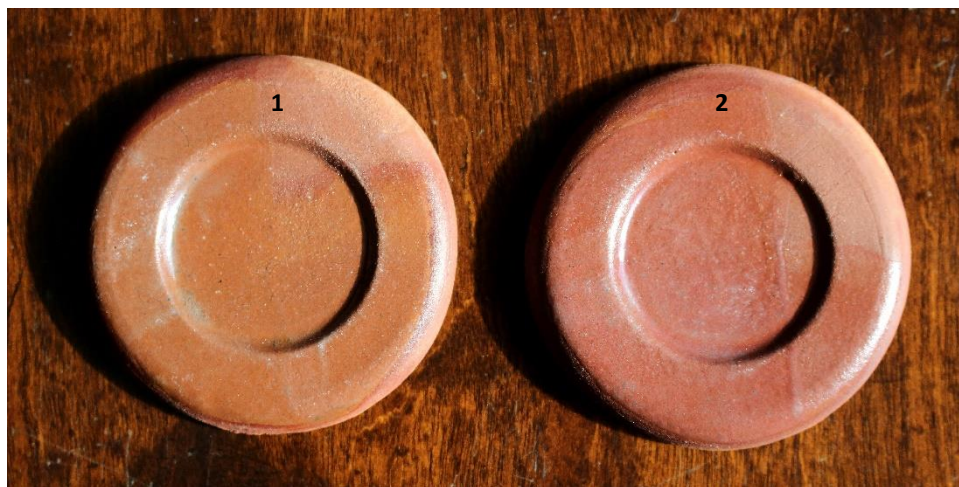
Kuva 14. Väripigmentin vaikutus lasitteeseen: 1. 2 paino-% \text{Fe}_2\text{O}_3 ja 2. 2 paino-% \text{Fe}_2\text{O}_3 + 5 paino-% K2278 kirsikanpunainen pigmentti.
