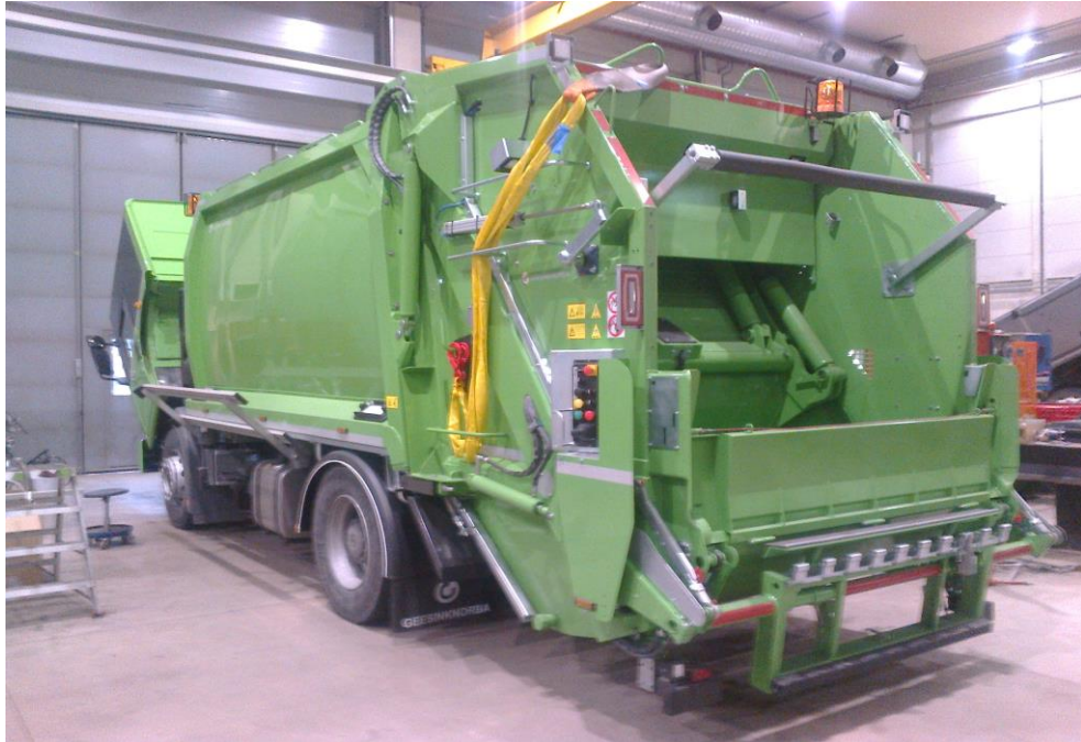
KUVA 4. Jätepakkari varustettuna yhdellä isolla säiliöllä
