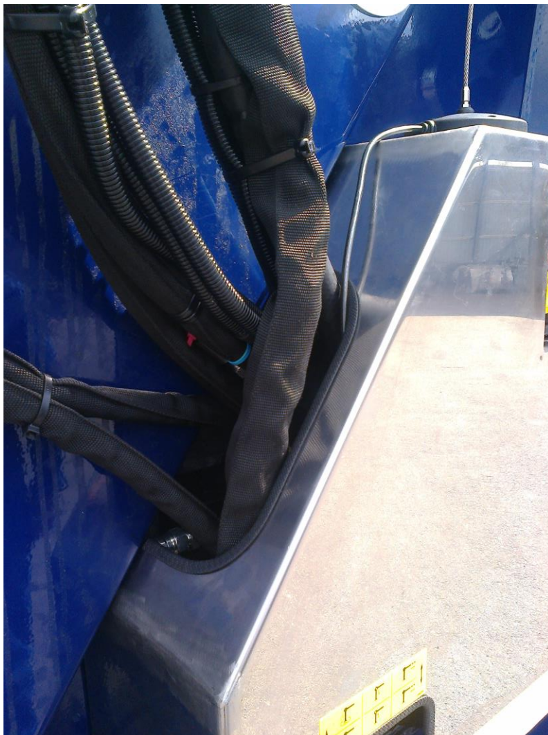
KUVA 27. Ohjausventtiileiden letkut pistosuihkusuojalla suojattuna
