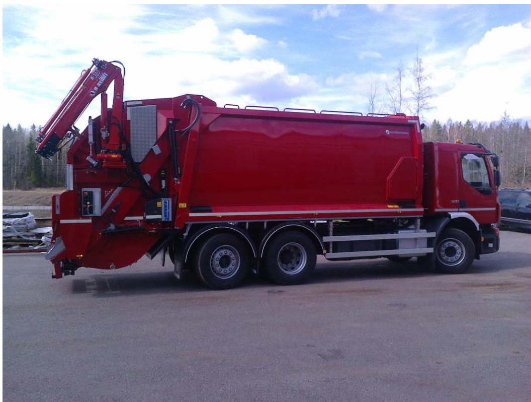
KUVA 9. Peräporttiin asennettu nosturi
