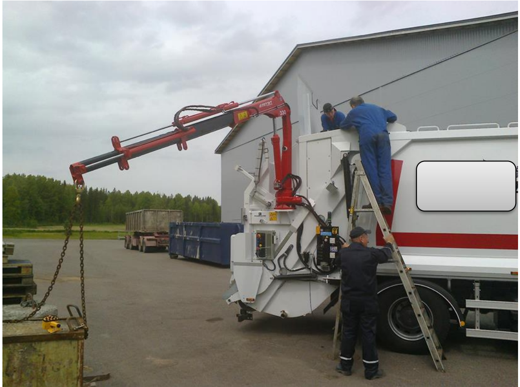
KUVA 31. Vakavuuskoe ja tilavuusvirran säätö.
