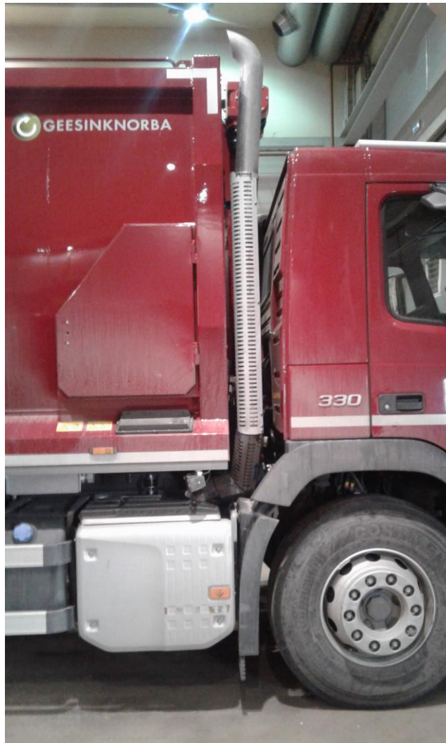
KUVA 3. Yläpuolisella ulostulolla varustettu pakoputki
