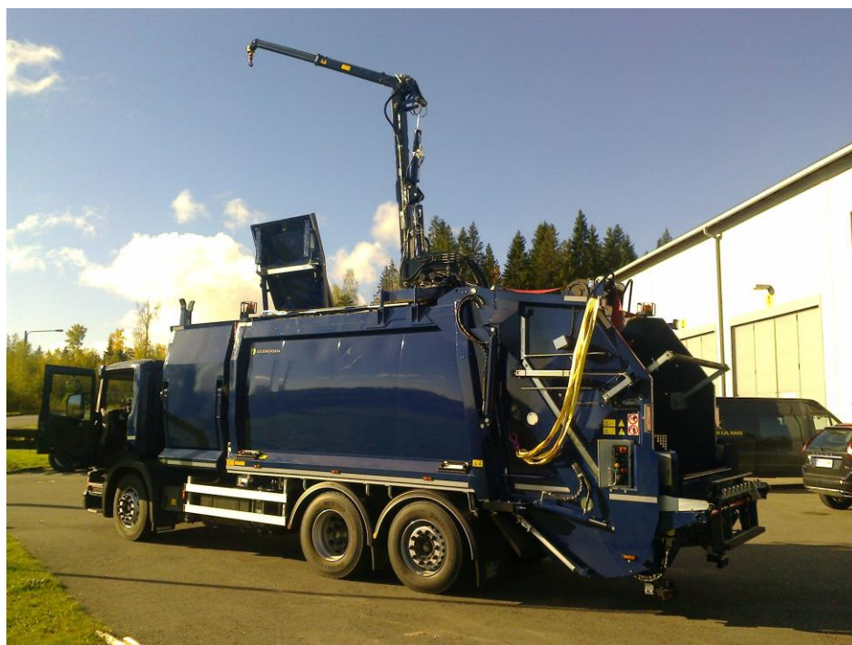
KUVA 8. Säiliön päälle asennettu nosturi
