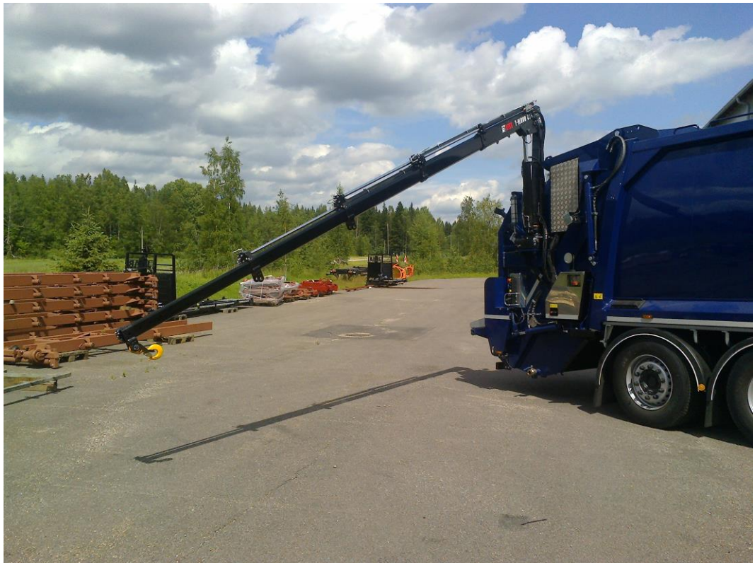
KUVA 1. Kuormausnosturi asennettuna jätepakkariautoon
