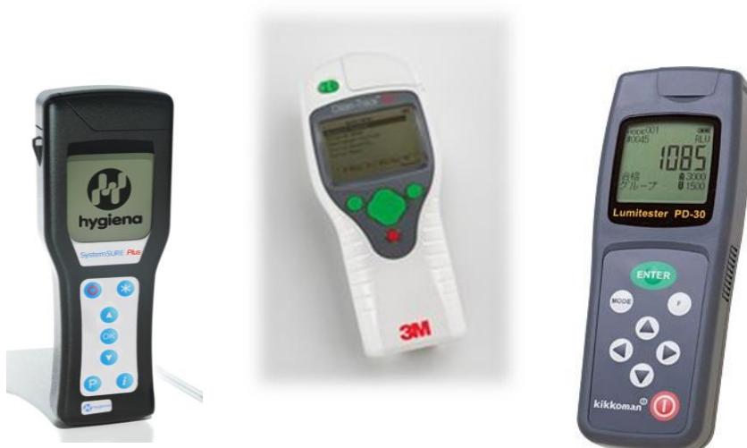
KUVA 3. Erilaisia luminometreja (Hygiena 2017b; 3M 2016b; Kikkoman 2017.)
