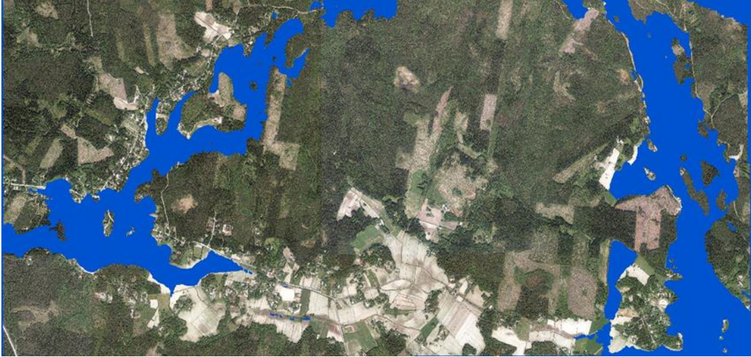
Figur 19: Visualisering i Arcscene med laserskannat material som terrängmodell. Vattennivån är höjd till 1600-talets nivå och man kan jämföra resultatet med figur 18 där man använt höjddata 2 m som terrängmodell.
