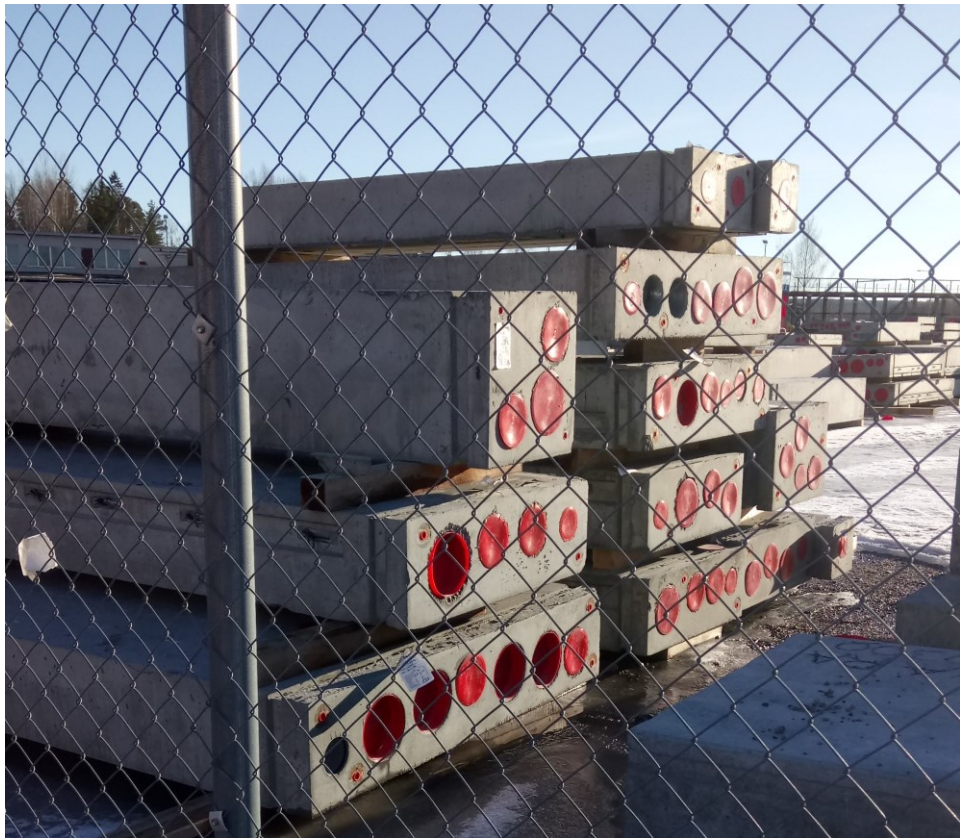
Kuva 3. Luja-hormielementtejä varastoituna nykyiseen varastoon
