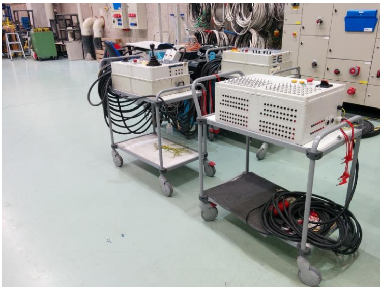
KUVA 18. Kytkinkotelot liikuteltavan alustan päällä
