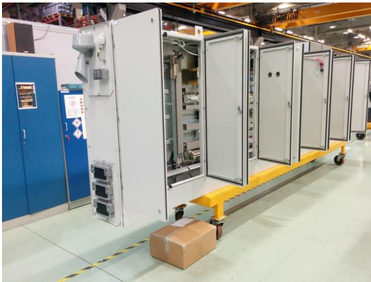
KUVA 16. Sähkökaappi liikuteltavan alustan päällä
