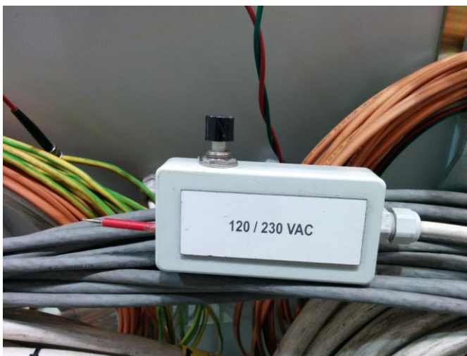
KUVA 27. RTG-koeajon itsevalmistettu hyppylankalaite
