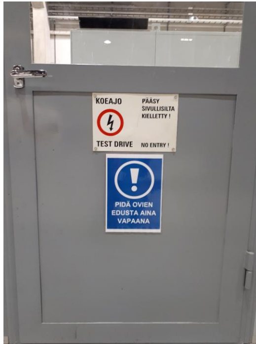
KUVA 10. Sähkökaappien ja -huoneiden testausalueen varoituskilpi
