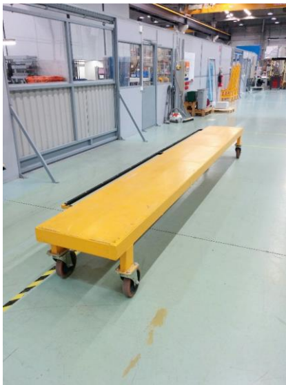
KUVA 19. Eristämätön sähkökaapin testausalusta
