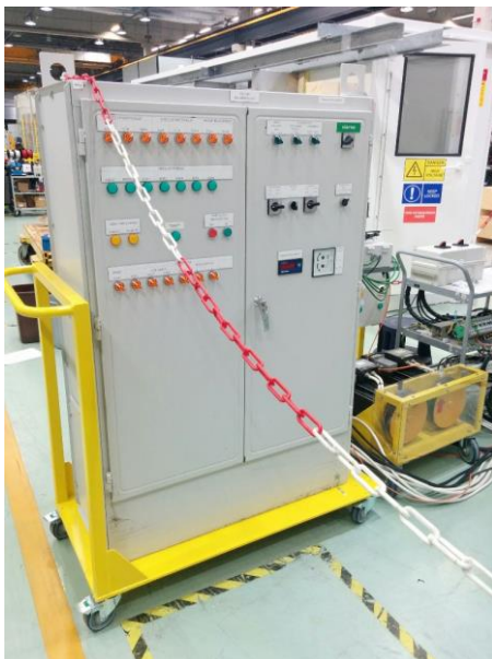
KUVA 7. RTG-nosturin ala-asema ja ketju sijoitettu väärin
