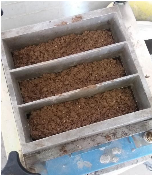
KUVA 2. Puoleen väliin täytetty prismamuotti
