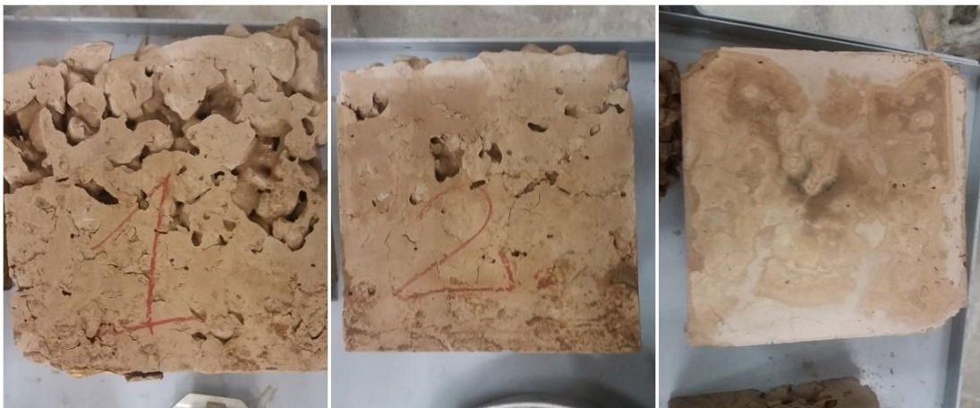
KUVA 7. Sideaineliete kappaleet 1, 2 ja 4 kovettuneina. Kappale 3 ei näy kuvassa.
