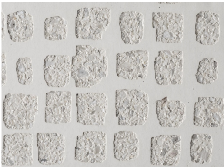
Kuva 2. Esimerkki graafisesta valkobetonista.
