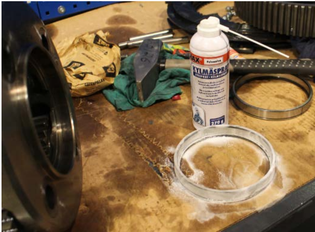
Kuva 9. Jäähdytetty laakerin kehä.
