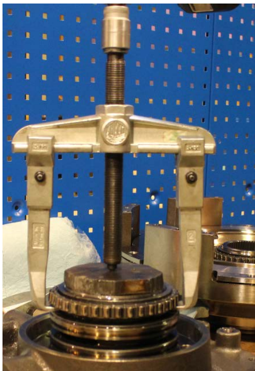
Kuva 1. Laakerin irrotus ulosvetäjällä.
