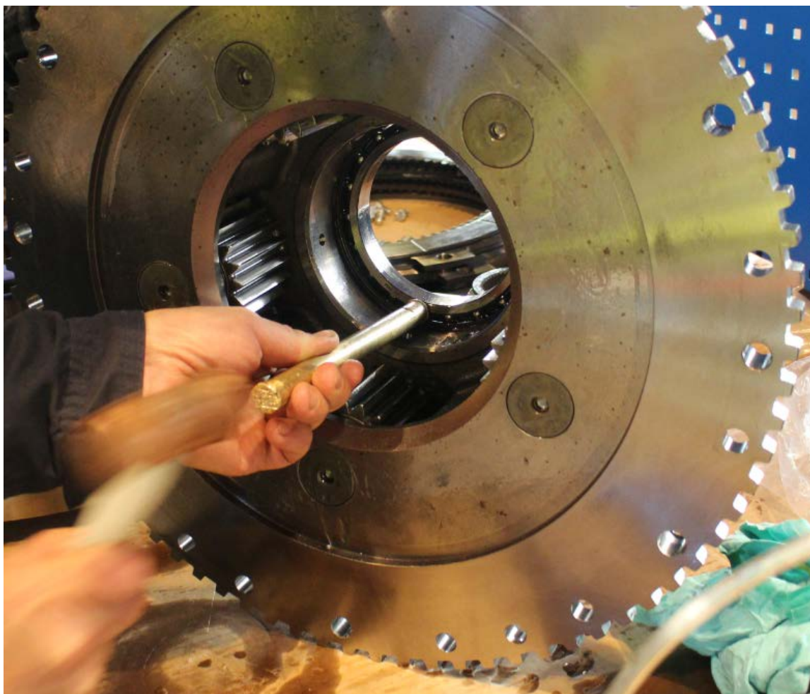
Kuva 3. Laakerin irrotus lyömällä.
