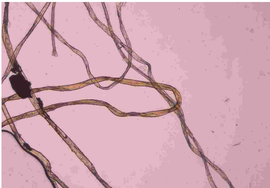
Kuva 18. Mikroskoopilla otettu kuva vaunujen nukasta. Kierteisyys on tyypillinen puuvillalle. (Kinnunen 2017)
