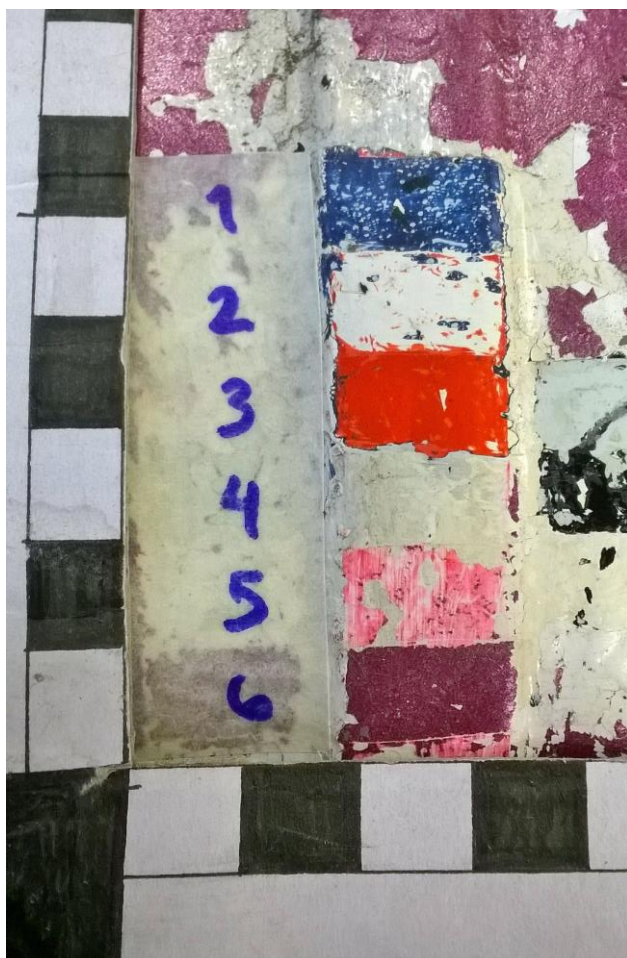
Kuva 21. Väriportaikko tehtiin hevosen vasemmalle puolelle polkijasta nähden. Portaikko oli suitsissa, joissa oli useampia maalikerroksia kuin muissa kohdissa. Kerroksia oli seitsemän, sillä punaisen (numero 3) ja valkoisen (numero 4) välissä oli musta kerros, jota ei onnistuttu raaputtamaan esiin hevosen tällä puolella. (Kinnunen 2017)
