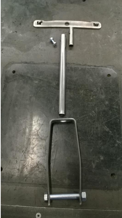
Kuva 31. Keskitangon osat. Poikkitanko, kaksi eri paksuista teräsputkea, haarukka ja kaksi eri kokoista pulttia muttereineen. (Kinnunen 2017)
