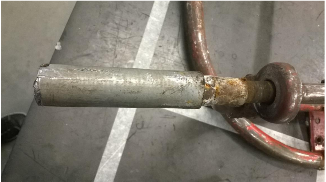
Kuva 25. Akseliin hitsattu sovitusputki toi lisää paksuutta, jotta nokkakärryn pyörät oli saatu kiinni. (Kinnunen 2017)
