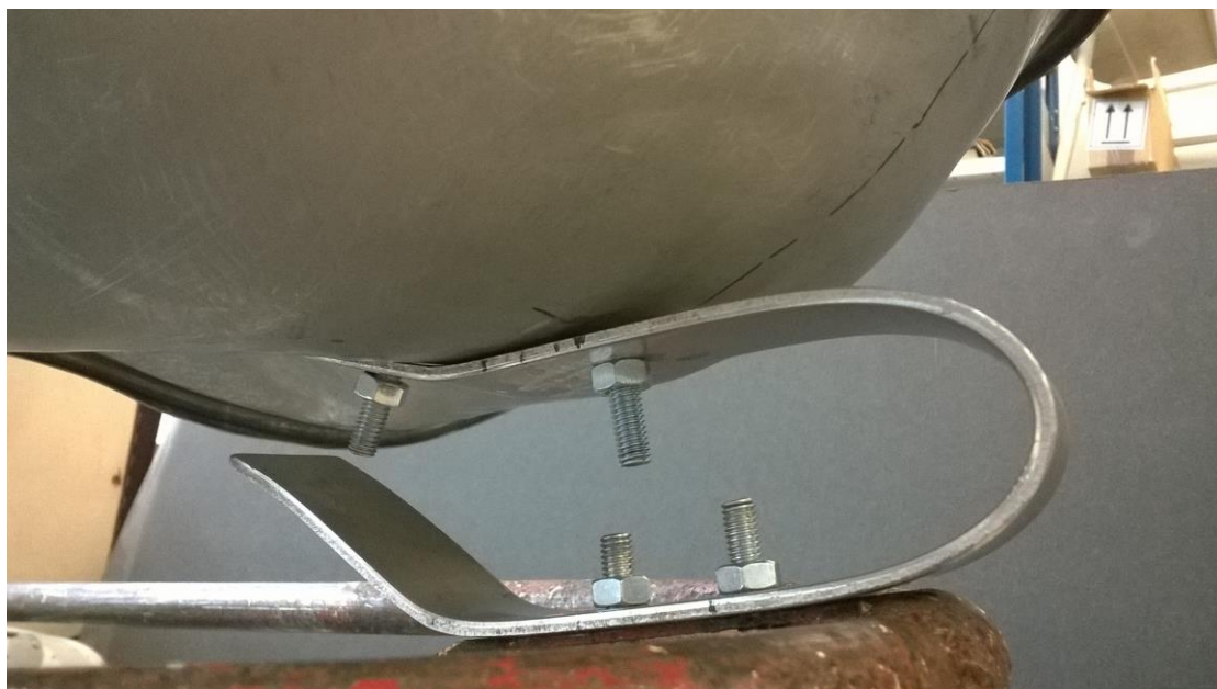
Kuva 29. Istuin ja kiinnitystanko pulteilla ja muttereilla kiinnitettynä vaunuihin. (Kinnunen 2017)
