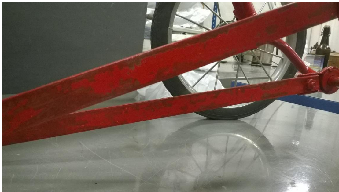
Kuva 33. Polkimien varsissa ollutta alkuperäistä maalia suojeltiin, maalaamalla uusi maali varovasti alkuperäisen kerroksen ympärille. Alkuperäinen maali näkyy kirkkaampina läiskinä kuvassa. Toinen maalikerros tasoitti värieroa. (Kinnunen 2017)
