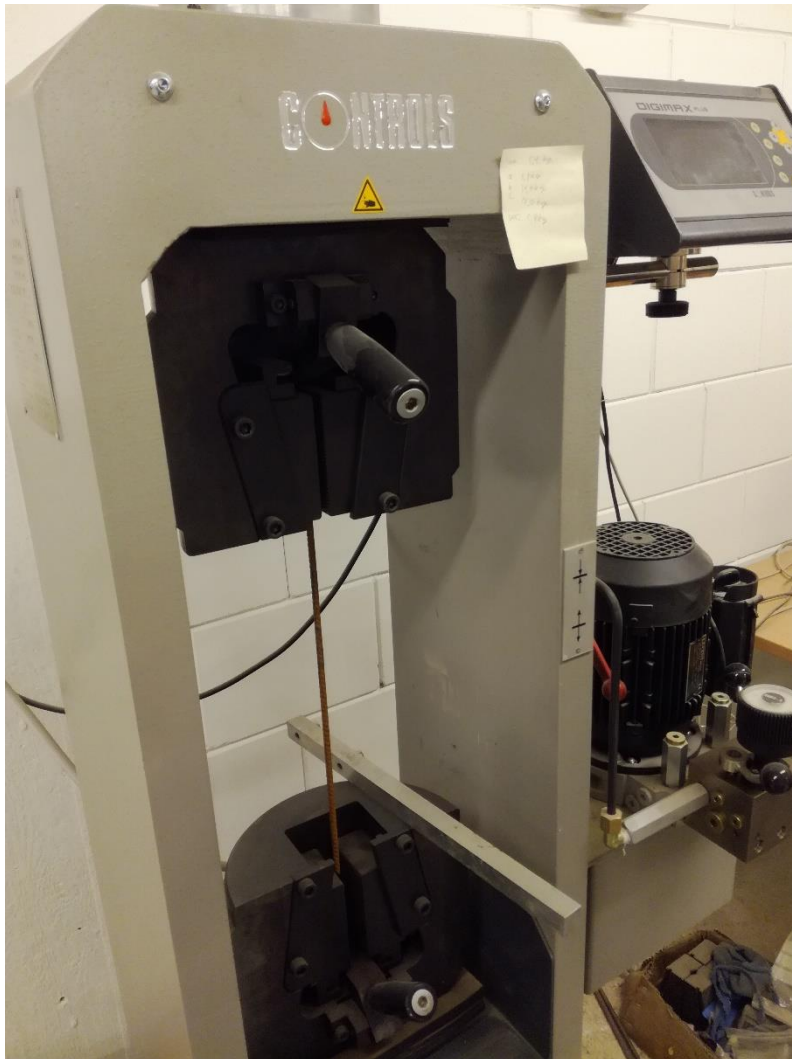
Kuva 8. Raudan vetolujuuden testauslaite
